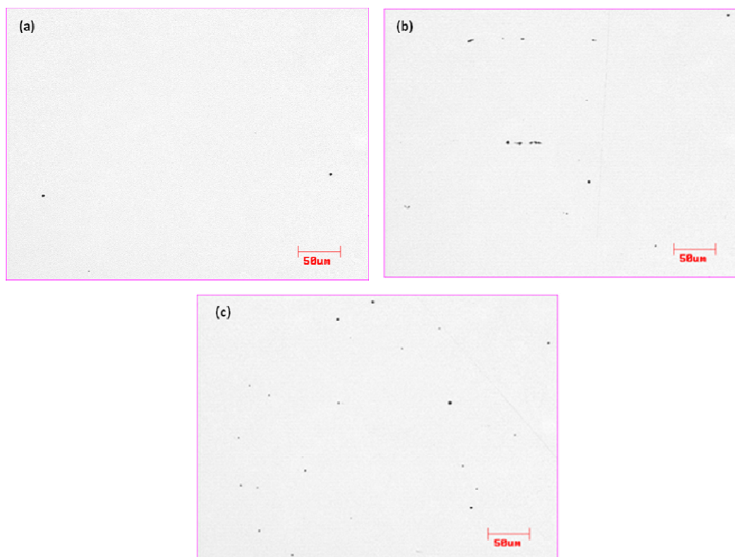
Figura 5.8: Resultado de micro pureza da amostra E1: (a) região de menor incidência de inclusões; (b) região mediana de incidência de inclusões e (c) região de maior incidência de inclusões.
