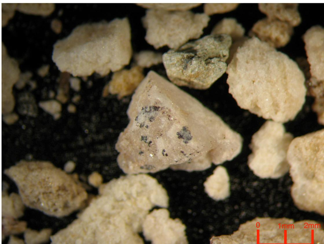
Figura V.9 (foto 35) – Amostra SJB02, fração >1,7mm (>12# Tyler), 10x aumento, detalhe 3: partícula de quartzo leitoso incrustada com minerais de ferro, ao centro.
