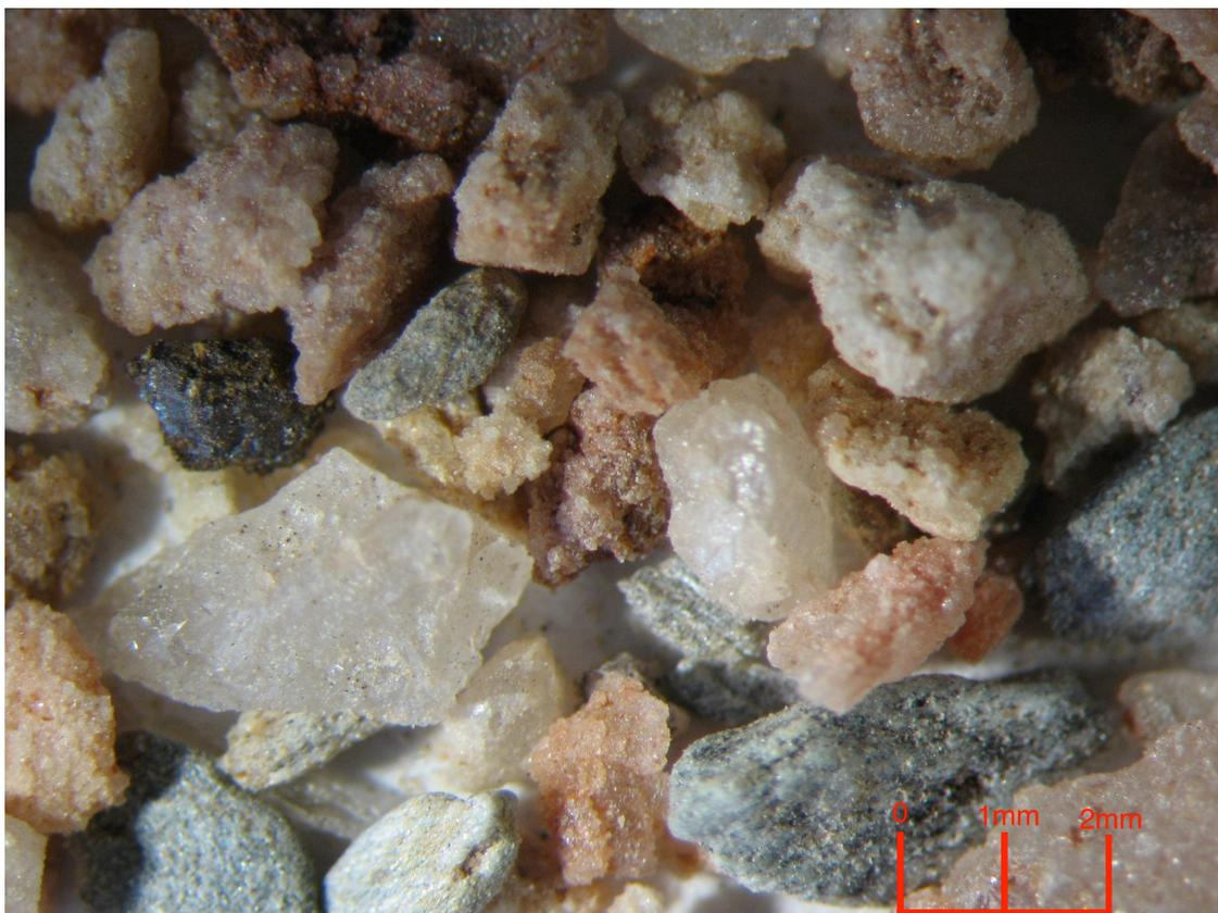
Figura V.16 (foto 1) – Amostra SJB01, fração >1,7mm (>12# Tyler), 10x aumento, detalhe 1. Presença de dois fragmentos de itabirito no canto inferior direito da foto, e outro no canto inferior esquerdo.
