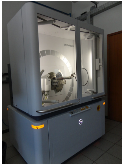
Figura 4.4 Difratorômetro de raios X utilizado para a caracterização de fase nas amostras.
