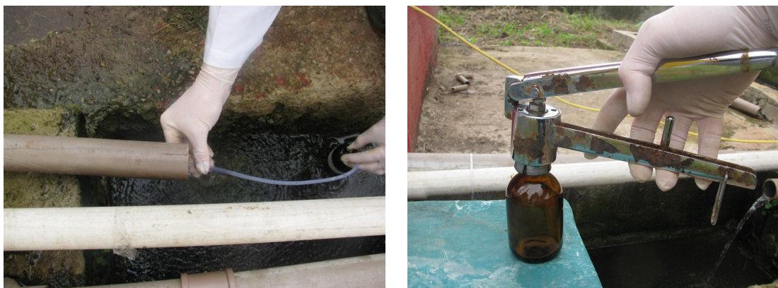
FIGURA 5.13: Procedimentos de coleta das amostras para análise de propano no líquido: (a) coleta com mangueira de silicone na tubulação de saída; (b) lacre do frasco de coleta com amostra.
