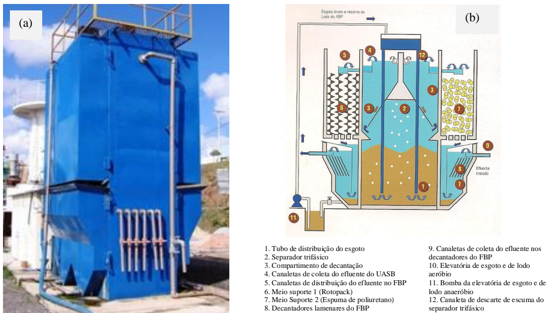
FIGURA 3.6: Sistema compacto UASB/FPB do tipo retangular desenvolvido no DESA/UFMG: (a) Fotografia do sistema; (b) detalhe esquemático dos componentes do sistema. Fonte: CePTS UFMG/COPASA.
