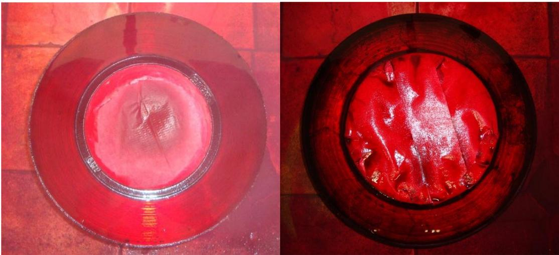
FIGURA 4.3 - Disco com penetrante aplicado dentro de um bojo
