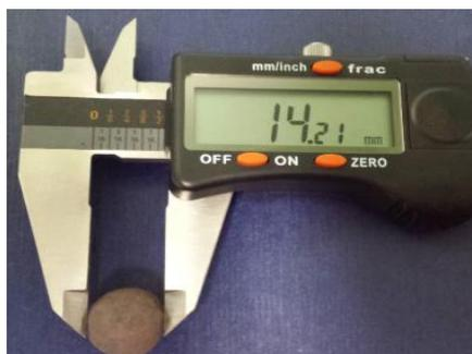
Figura 4-4: Metodologia de determinação da esfericidade pelo uso do paquímetro em uma amostra de pelota.
