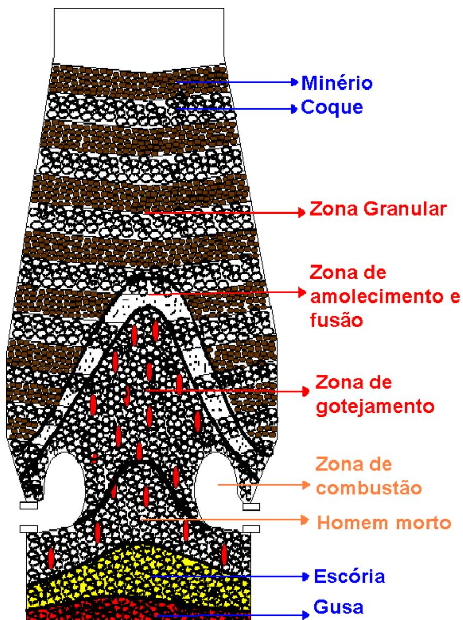
Figura 3-2: Esquema da região interna do alto-forno, mostrando as várias zonas (CASTRO, 2002).
