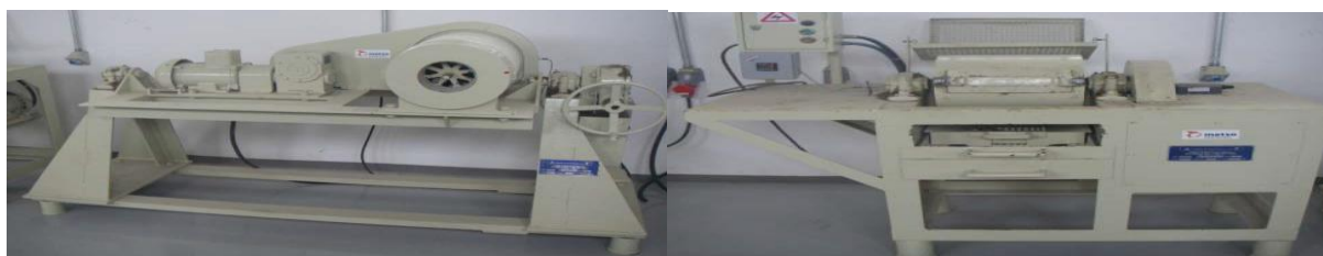
Figura 4.6: Moinhos de barras e bolas usados em testes de WI. (Fonte: Laboratório METSO)
