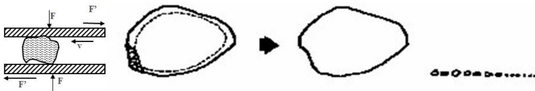
Figura 3.8: Cominuição por abrasão ou cisalhamento. (Fonte: GOMES, 2010)
