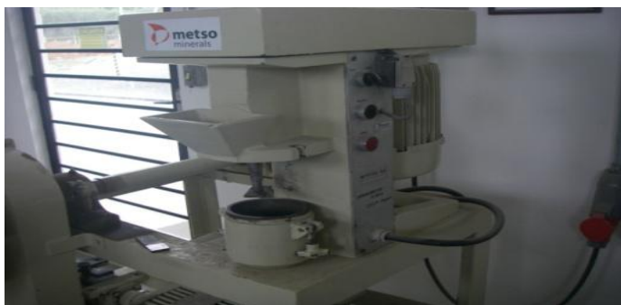
Figura 4.5: Aparelho para testes de abrasividade e britabilidade (MACON). (Fonte: Laboratório METSO)
