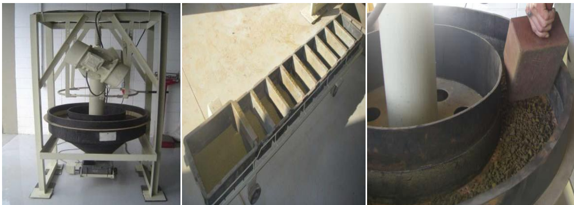
Figura 4.8: Peneiras circulares para testes de peneiramento. (Fonte: Laboratório METSO)
