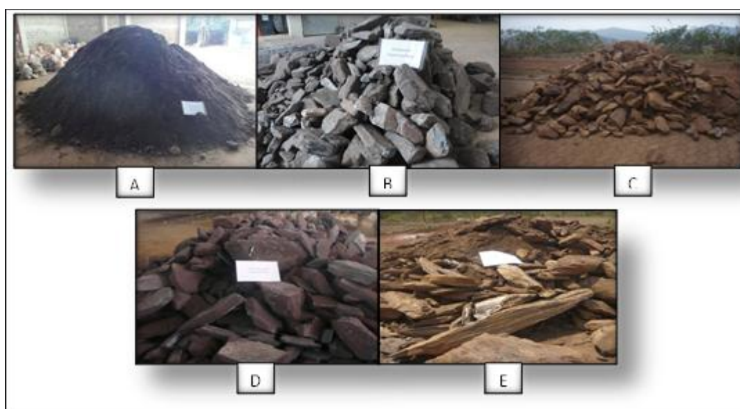
Figura 4.1: Amostras de minérios itabiríticos. (A) Amostra Padrão, (B) Compacto Especularítico, (C) Compacto não Especularítico, (D) Semi-compacto Especularítico e (E) Semi-compacto não Especularítico. (Fonte: Laboratório PCM, 2013)
