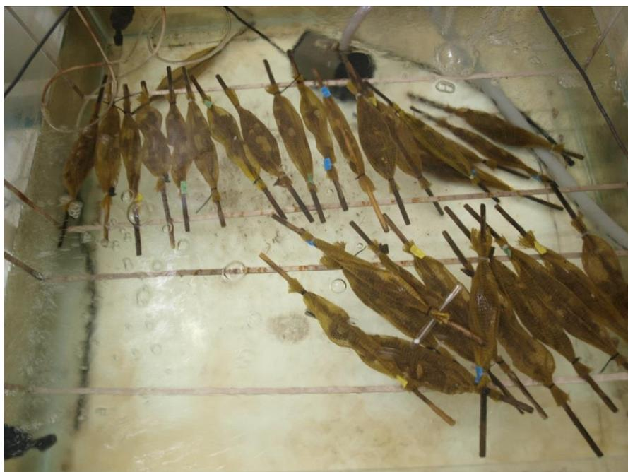
**Figura 4.9** – Amostras de madeira no aquário para incrustação.
