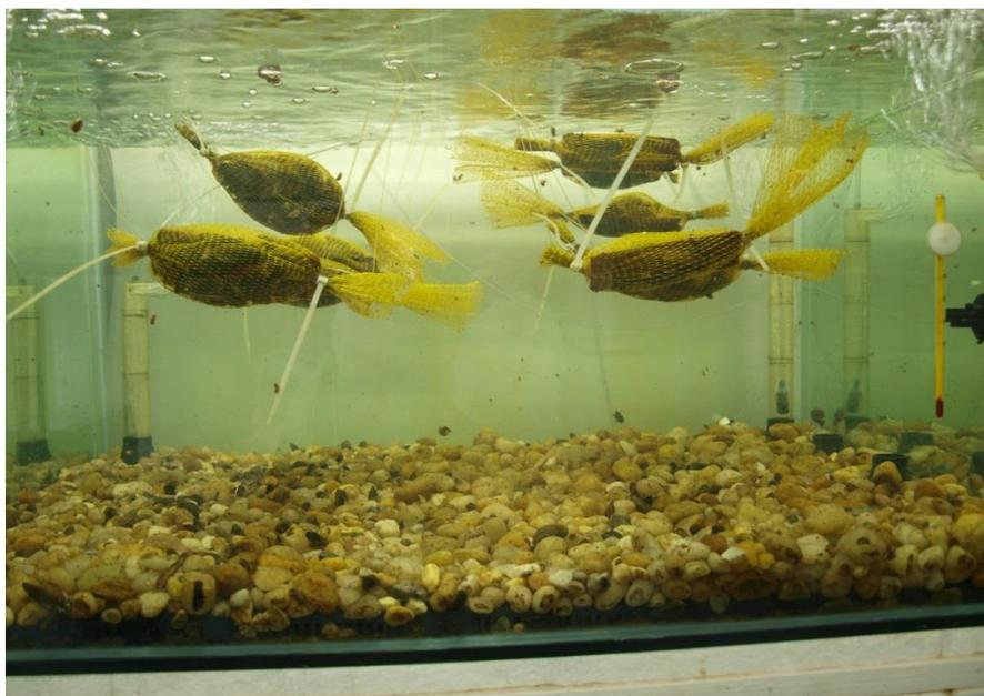
**Figura 4.10** – Amostras de aço no aquário para incrustação.
