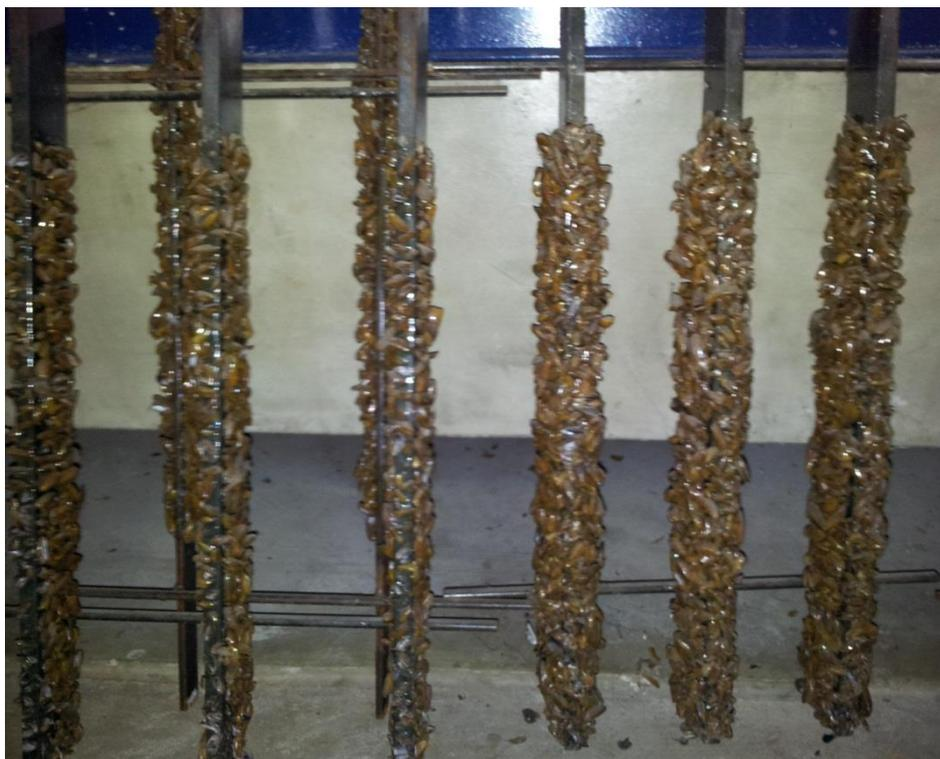
**Figura 3.9** - Grade incrustada artificialmente pelo mexilhão dourado, imitando a incrustação que ocorre em campo.
