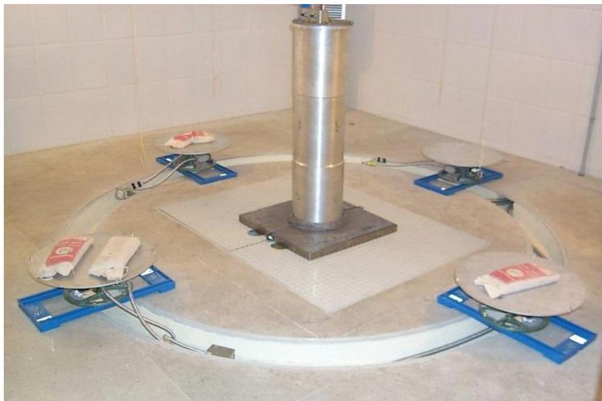
**Figura 4-** Posição das mesas de radiação. O tubo central contém a fonte de Cobalto-60.
