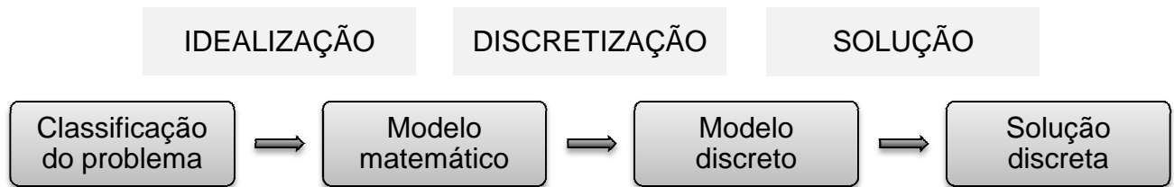
Figura 73 - Diagrama do processo de uma análise por MEF.
