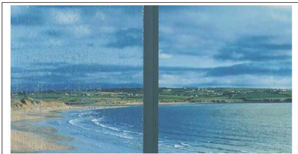
Figura 8: Vidro sem nano-tiO 2 à esq. e à direita vidro com nano-tiO 2 incorporado. Fonte: PARAMES, 2010.
