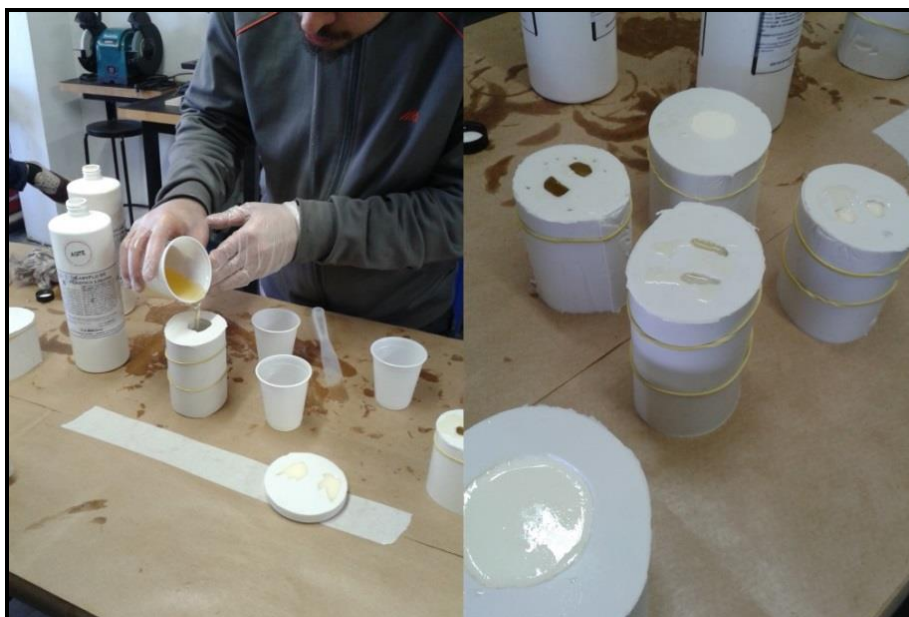
Figura 29 - Processo de produção dos toys – enchimento do molde Fonte: Acervo da autora
