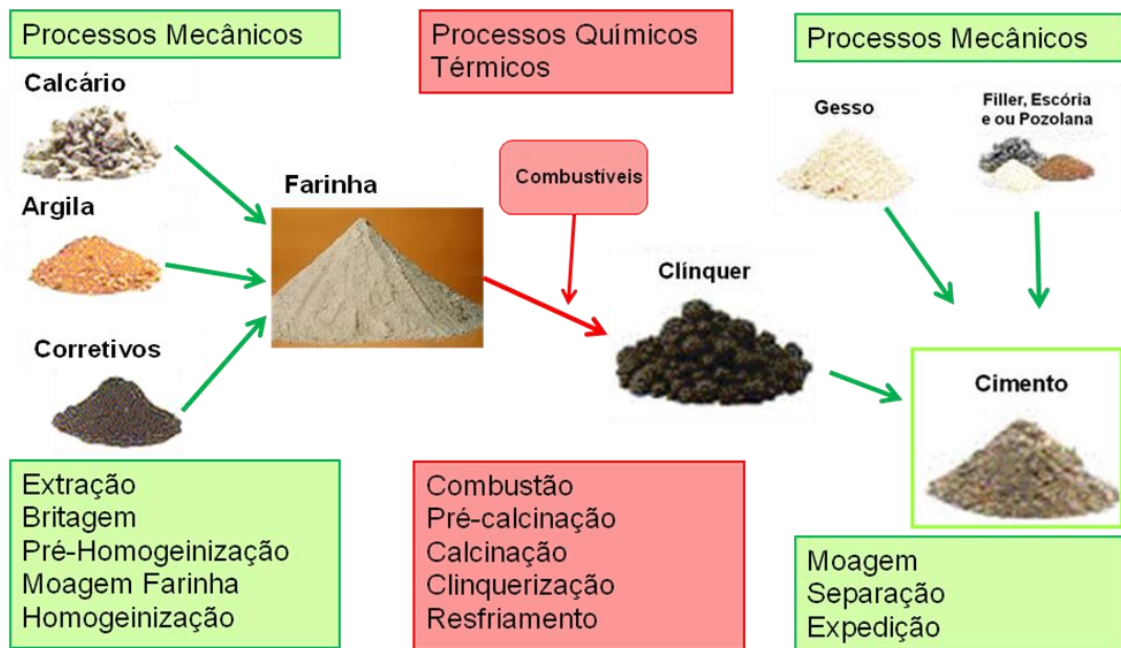
Figura 1 – Processo industrial de fabricação de cimento: etapas e subprodutos.
