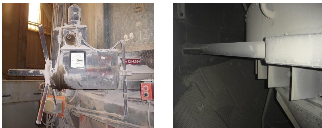
Figura 17 – Volante externo e eixo para giro das gelosias.
