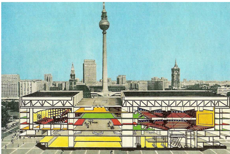
FIGURA 4.19: Corte esquemático do Palácio da República Câmara do Povo à esquerda, Foyer Principal ao centro e o Grande Salão à direita. Fonte: HOLFELDER, 2008, p.118.
