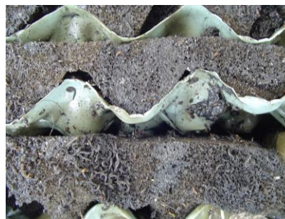
(B) Detalhe da presença de larvas, encontradas principalmente nos compartimentos superiores (1,05 e 2,10 m) do FBP
