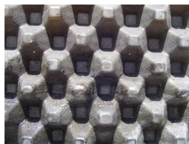
(C) Aspecto da placa após a remoção da biomassa
