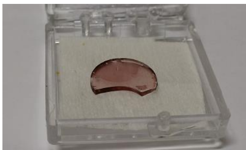
Figura 3.6 – Filme de P3HT em Zeonex ® sobre um substrato de quartzo, fabricado através da técnica de spin-coating.
