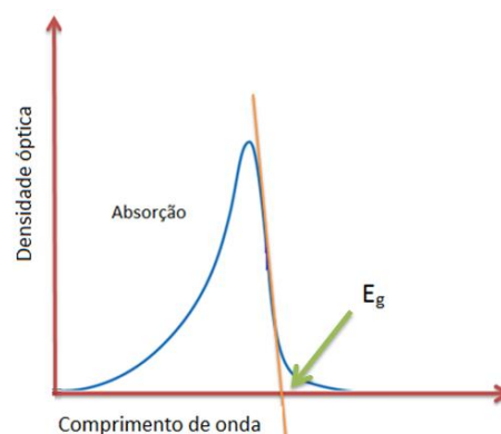
Figura 2.4 - Método da tangente utilizado para determinação de E_g de uma amostra polimérica.
