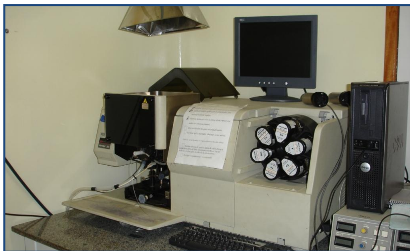
Figura 4-2: Espectrofotômetro de absorção atômica.
