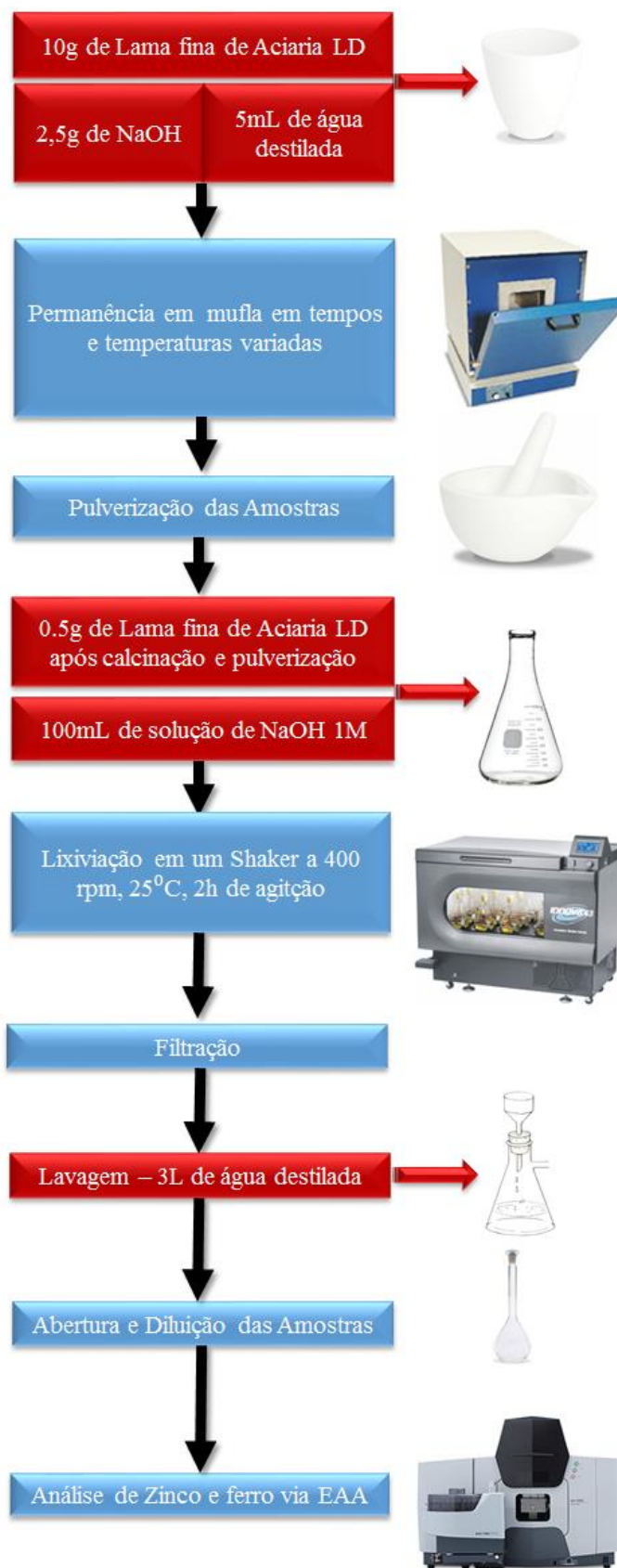
Figura 4-6: Sequência dos ensaios de digestão térmica da franklinita.
