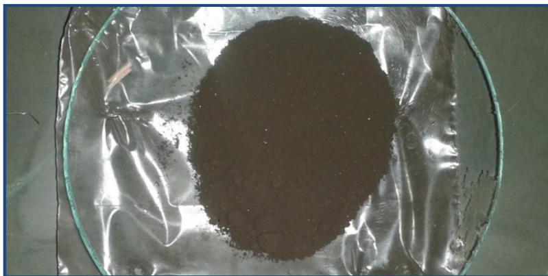
Figura 4-1: Aspecto da lama fina de aciaria LD após a secagem e fragmentação.
