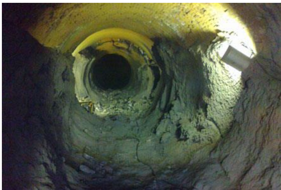
Figura 3-4: Cascão metálico incrustado no interior do Forno Waelz, unidade da Votorantim Metais, Juiz de Fora – MG, meramente para demonstrar a diminuição do volume do reator e os malefícios desta formação.
