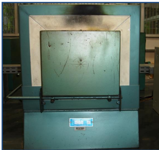
Figura 4-4: Mufla utilizada nos experimentos de digestão térmica alcalina da lama.
