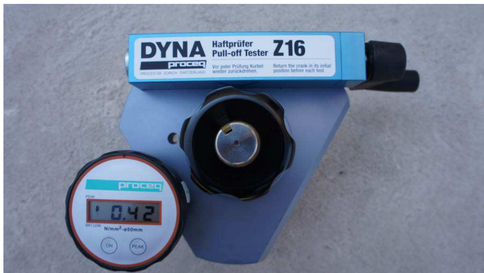
Figura 4.18 – Detalhe do equipamento DYNA Z16 durante o ensaio de resistência de aderência à tração no painel 1 de argamassa.
