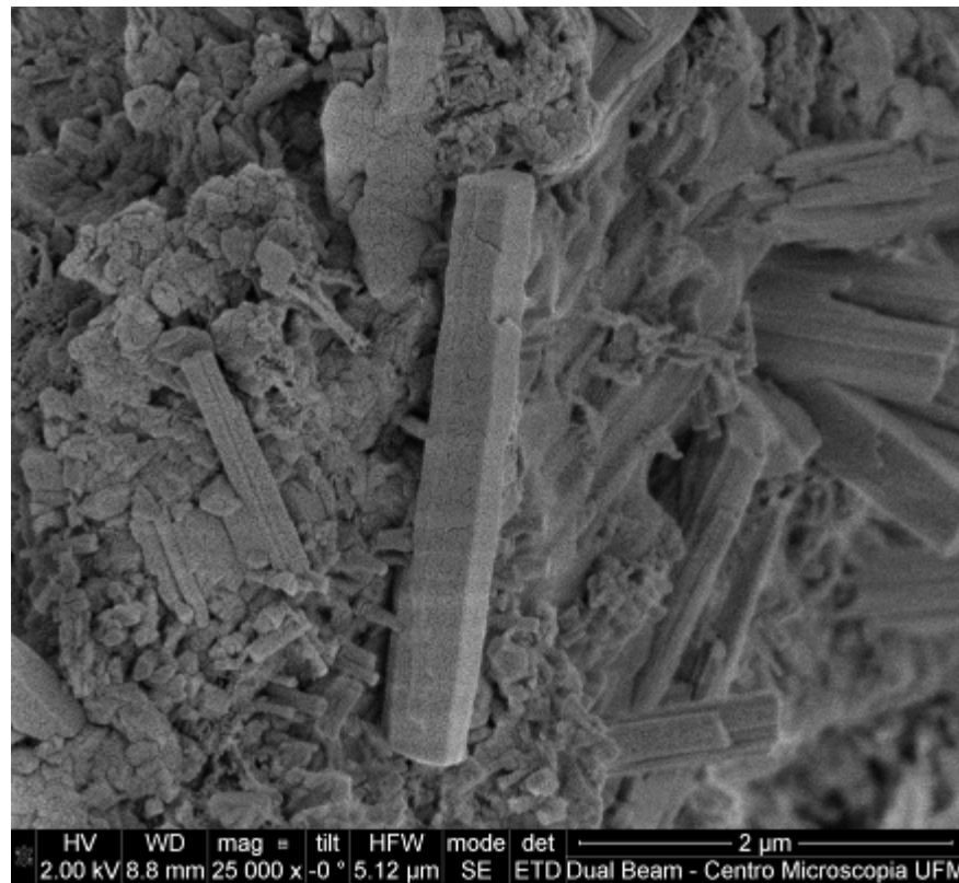
Figura 5.96 – Fotomicrografia da superfície da argamassa de chapisco (recobrimento com ouro).
