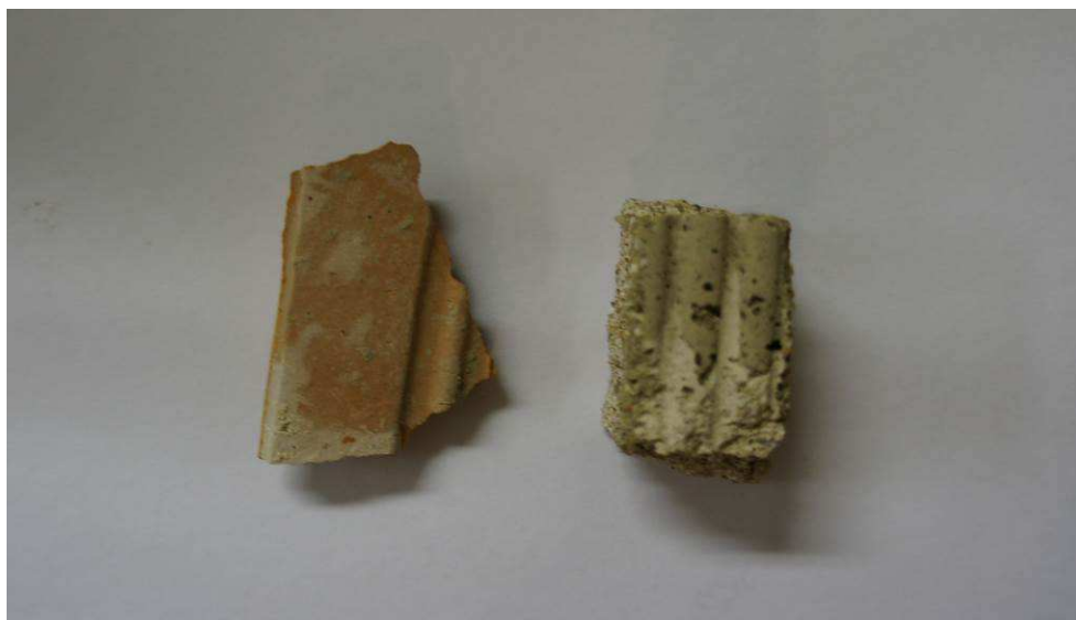
Figura 4.42 – Amostras de argamassa sem recobrimento e destacadas para microscopia e microanálise.
