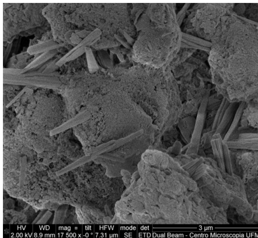
Figura 5.93 – Fotomicrografia da superfície da argamassa de chapisco (recobrimento com ouro).
