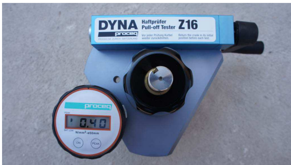
Figura 4.14 – Aparelho verificador Dyna “pull-off tester” para ensaio de resistência de aderência à tração.
