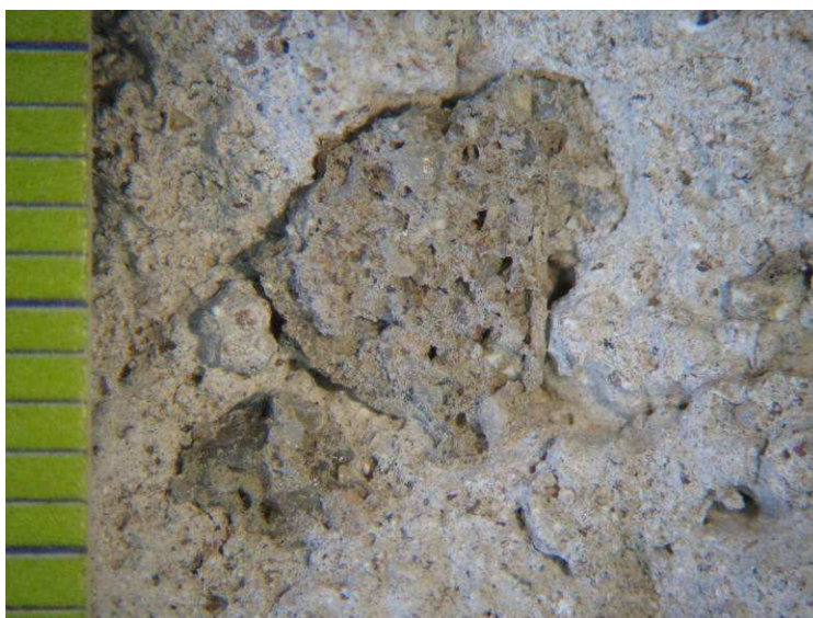
Figura 5.1 – Imagem macroscópica de amostra de argamassa de chapisco destacada do bloco cerâmico. Escala em milímetros.
