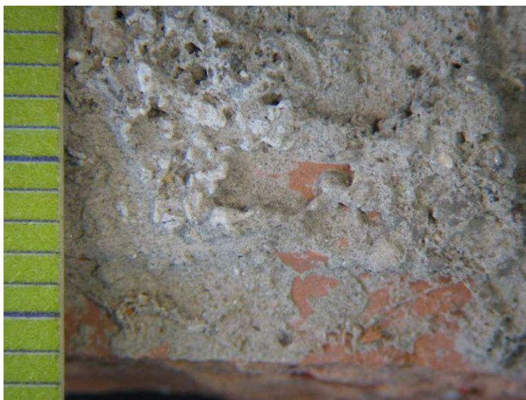
Figura 5.2 – Imagem macroscópica de superfície da argamassa de chapisco aderida sobre o bloco cerâmico. Escala em milímetros.
