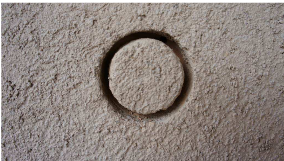
Figura 4.17 – Detalhe do corte com serra copo preparado para o ensaio de resistência de aderência à tração.
