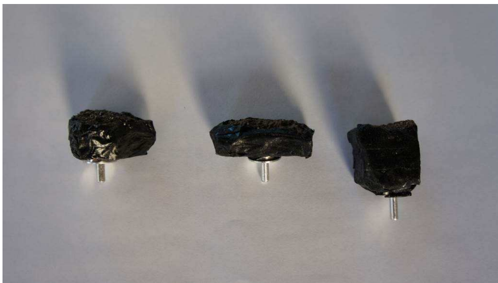
Figura 4.37 – Detalhe da fita condutora nas amostras montadas no suporte.
