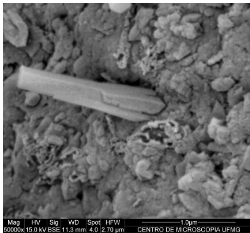
Figura 5.118 – Fotomicrografia da superfície da argamassa de revestimento (recobrimento com ouro).
