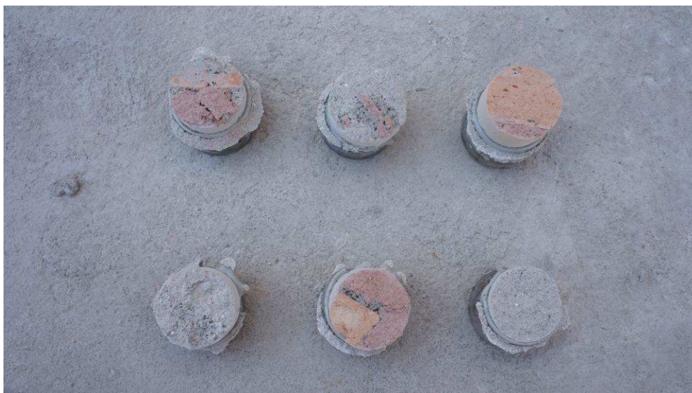
Figura 4.23 – Detalhe dos seis arrancamentos do painel 3 de argamassa no ensaio de resistência de aderência à tração.
