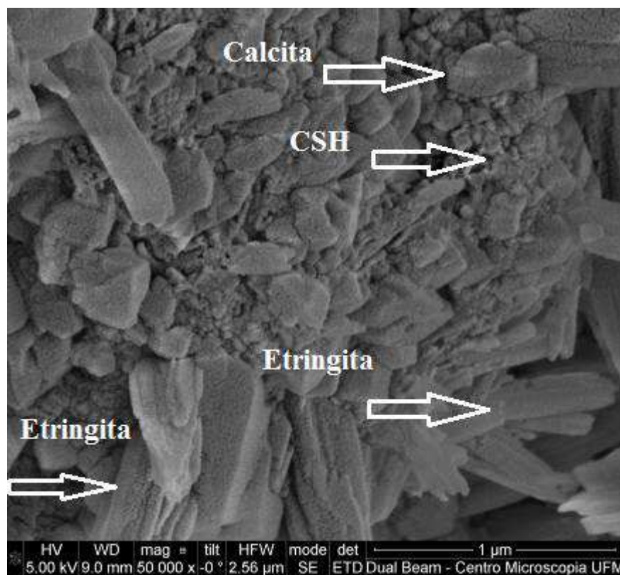
Figura 5.85 – Fotomicrografia da interface bloco cerâmico/argamassa de chapisco (recobrimento com ouro).
