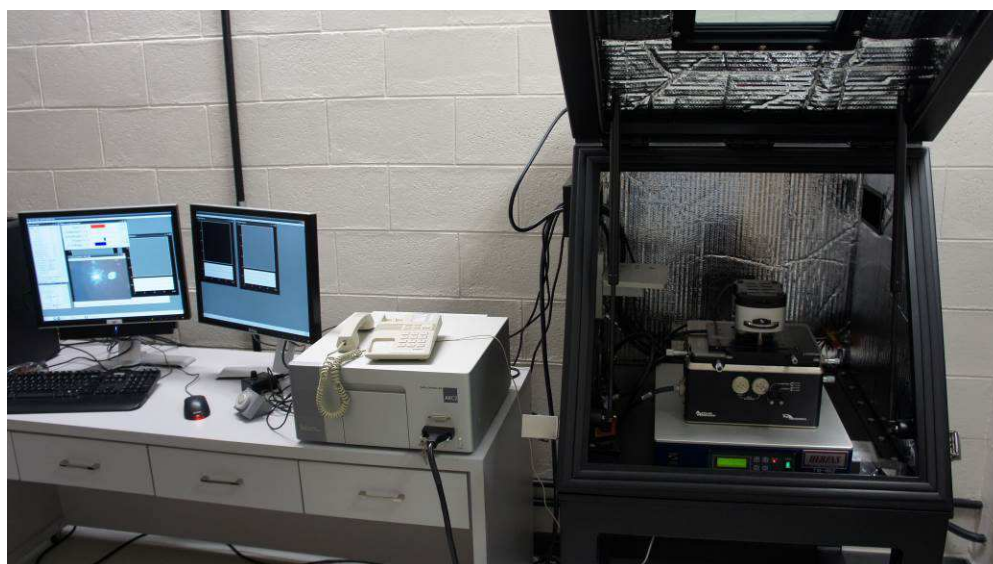
Figura 4.44 – Microscópio de força atômica (MFA), detalhe da câmara aberta.
