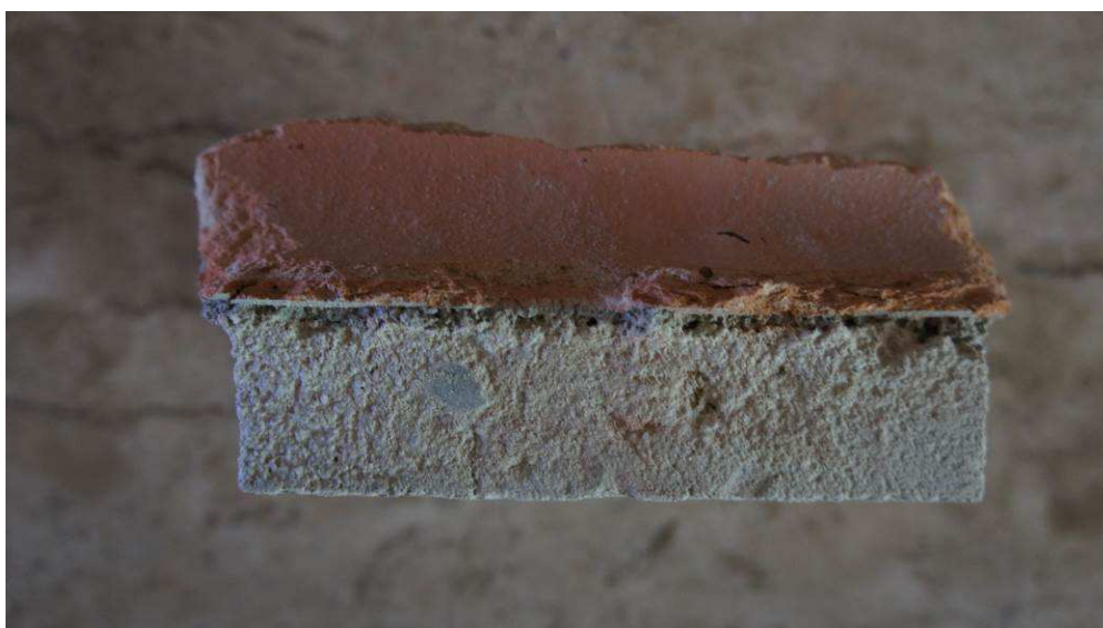
Figura 4.13 – Corte lateral da amostra retirada para as análises químicas, micro e nanoestruturais.
