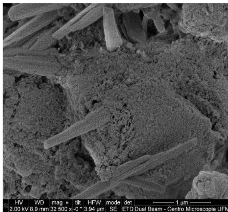
Figura 5.94 – Fotomicrografia da superfície da argamassa de chapisco (recobrimento com ouro).
