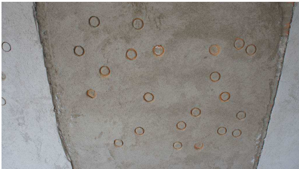
Figura 4.16 – Pannel de argamassa preparado para os ensaios de resistência de aderência à tração.
