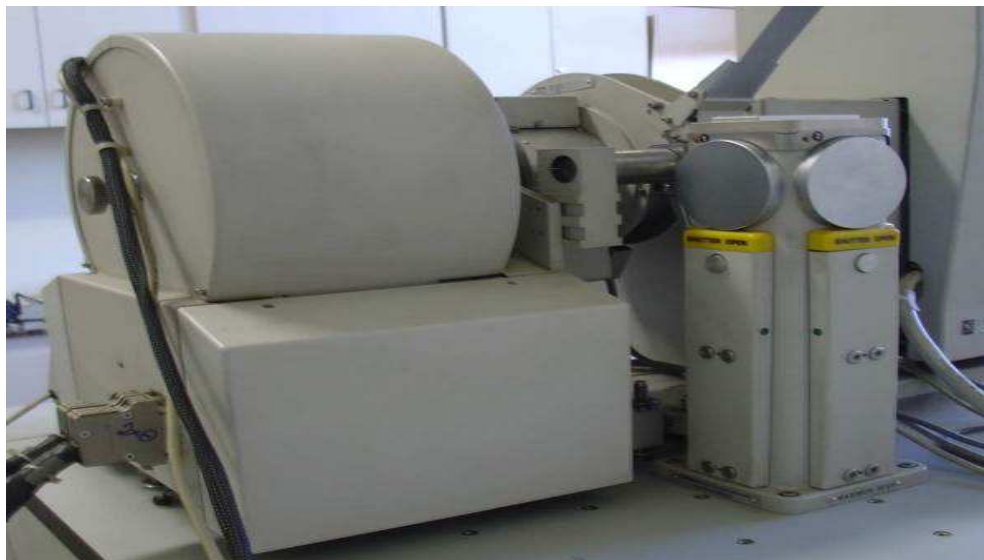
Figura 4.25 – Difratorômetro Philips modelo PW3710 equipado com tubo de raios-X com cátodo de cobre.
