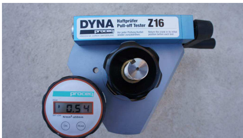
Figura 4.21 – Detalhe do equipamento DYNA Z16 durante o ensaio de resistência de aderência à tração no painel 3 de argamassa.
