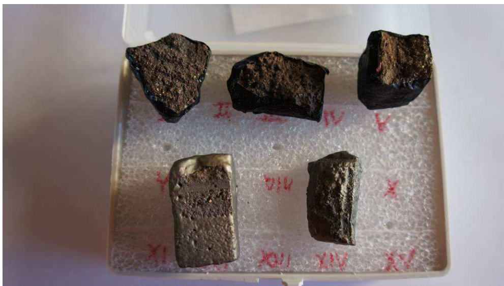
Figura 4.35 – Amostras recobertas/metalizadas com uma camada de 10nm de ouro.
