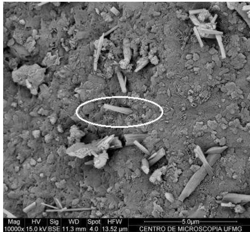
Figura 5.117 – Fotomicrografia da superfície da argamassa de revestimento (recobrimento com ouro).
