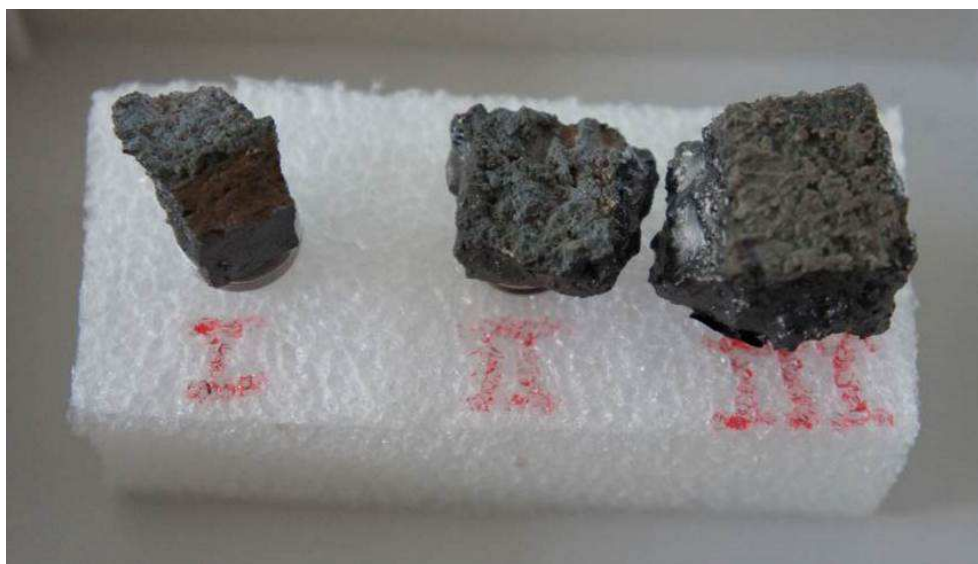
Figura 4.36 – Amostras recobertas/metalizadas com duas camadas de 5nm de carbono.
