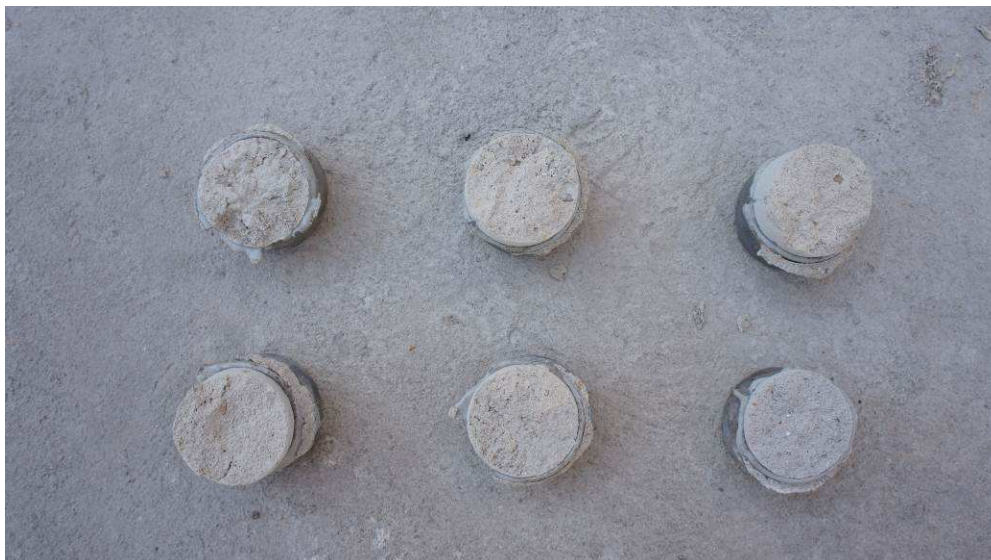
Figura 4.24 – Detalhe dos seis arrancamentos de um dos painéis de argamassa no ensaio de resistência de aderência à tração.
