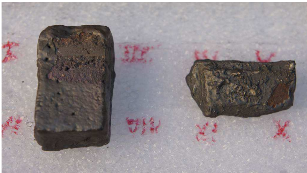
Figura 4.39 – Detalhe do recobrimento com ouro e da lateral pintada de carbono sem fita condutora.
