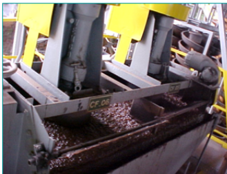
Fração -0,15mm: Underflow dos hidrociclones deslamadores. (alimentação da flotação).
