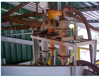
Fração -0,15mm: Underflow dos hidrociclones deslamadores. (alimentação da flotação).
