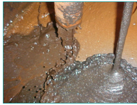
Fração -0,15mm: Underflow dos hidrociclones deslamadores. (alimentação da flotação).
