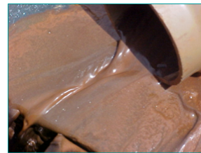
Fração -0,15mm: Overflow dos hidrociclones deslamadores (lama).
