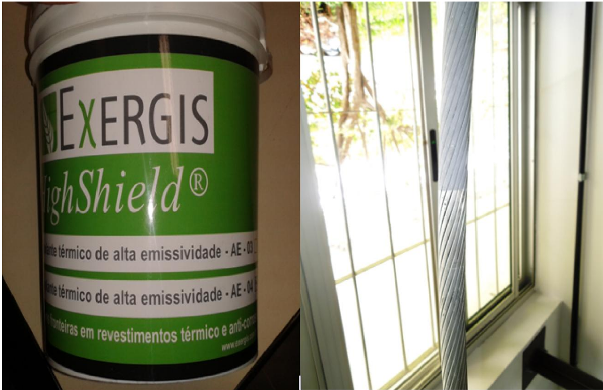
Figura 3.15. Galão do material de recobrimento e cabo com a metade superior pintada.
