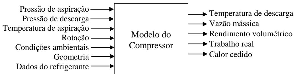
FIG.3-1 - Diagrama representando as variáveis de entrada e saída do modelo do compressor.
