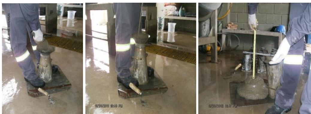
Figura 4.9: Ensaio de avaliação do *slump* do concreto convencional
