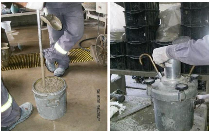
Figura 4.8: Ensaio de teor de ar incorporado.
