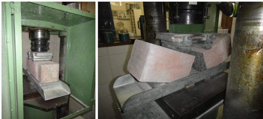
Figura 4.18: Equipamento de leitura de deformação digital do fornecedor Micro Sensores Industrial Ltda. ensaio de resistência à tração na flexão
