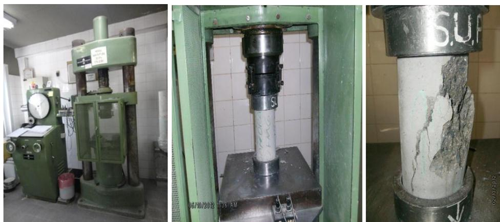
Figura 4.15: Ensaio de resistência à compressão
