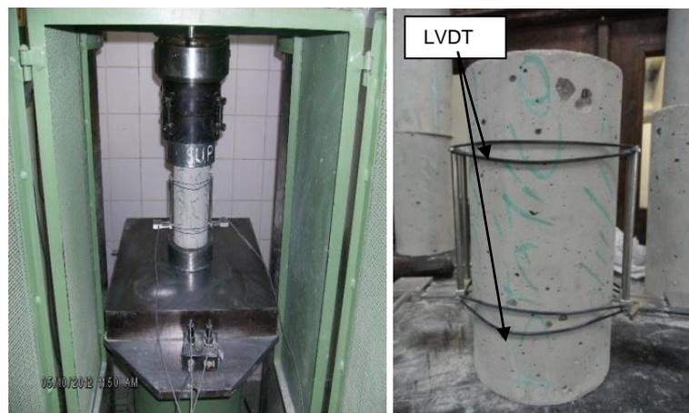
Figura 4.16: Ensaio de módulo de elasticidade estático secante e corpo de prova de concreto com sensores acoplados
