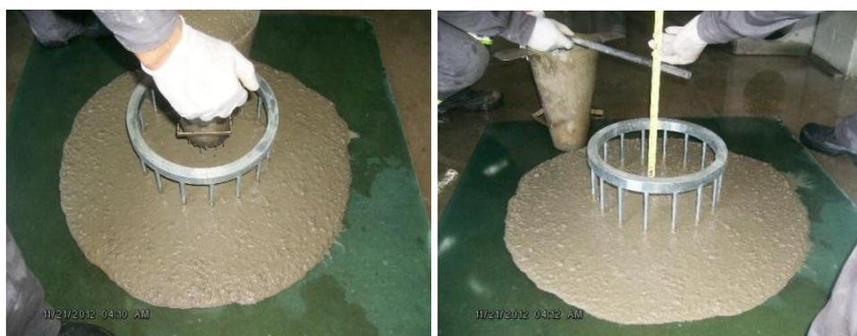
Figura 4.11: Ensaio anel -J (*J-Ring test*) para o CAA.
