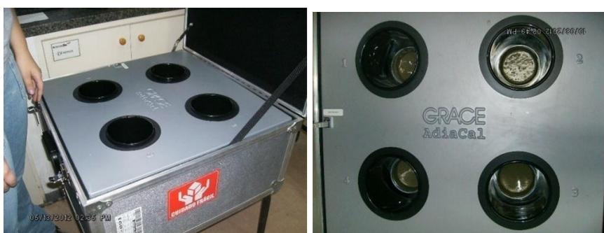
Figura 4.7: Equipamento para ensaio de calorimetria.
