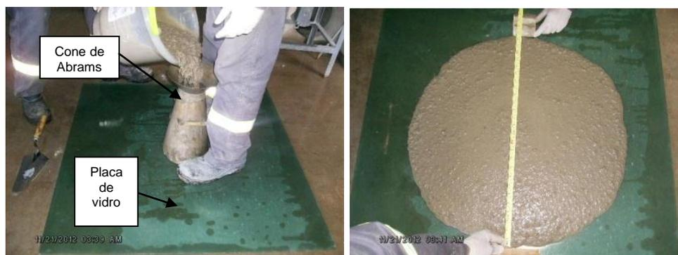
Figura 4.10: Ensaio testes espalhamento (*slump flow*,  $slump flow_{t_{500}}$ ) para o CAA
