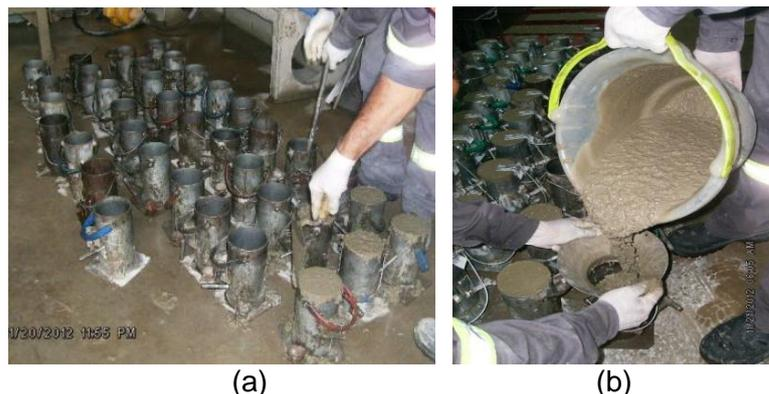
Figura 4.14: Moldagens dos corpos de prova cilíndricos 100x200 mm (a) CCV com adensamento; (b) CAA sem adensamento.
