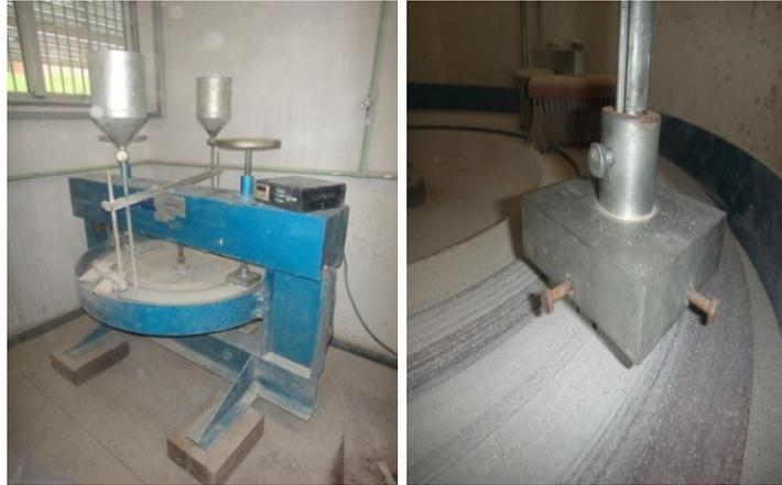
Figura 4.21: Ensaio de resistência à abrasão
