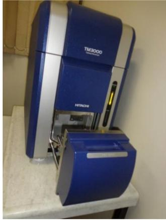
Figura 4.24: Microscópio eletrônico de varredura para o ensaio de análise microestrutural.
