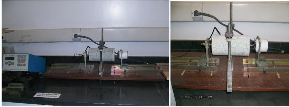
Figura 4.17: Equipamento para determinação do módulo de elasticidade dinâmico: *Erudite MKII Resonant Frequency Test System*.
