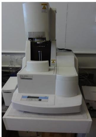
Figura 4.6: Equipamento para ensaio de análise termogravimétrica (TGA) e *análise termo diferencial (DTA)*.
