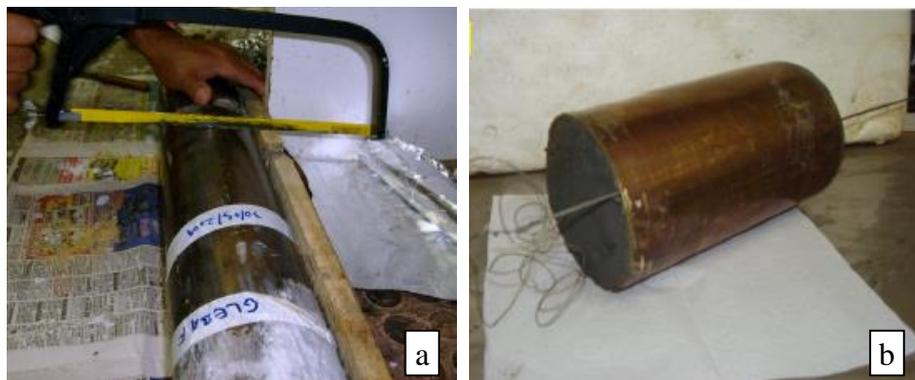
FIGURA 2.1 - Procedimento de extrusão e preparação de corpos de prova de solos moles em laboratório (Baroni, 2010)
