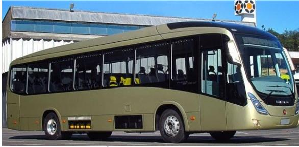
Figura 2.23 – Ônibus Viale BRT com tração híbrida (diesel/gás natural) – Hannover, Alemanha
