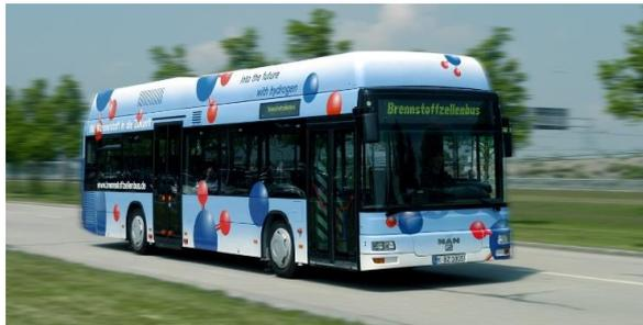
Figura 2.26 – Ônibus alemão de célula de combustível
