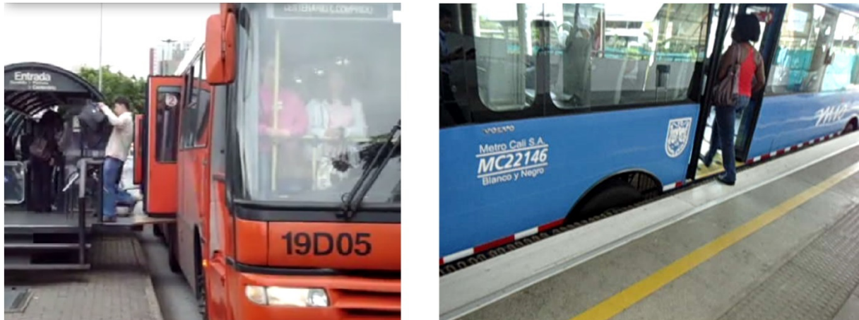
Figura 4.15 – Portas dos ônibus nos sistemas BRT de Curitiba (à esquerda) e de Cali (à direita)
