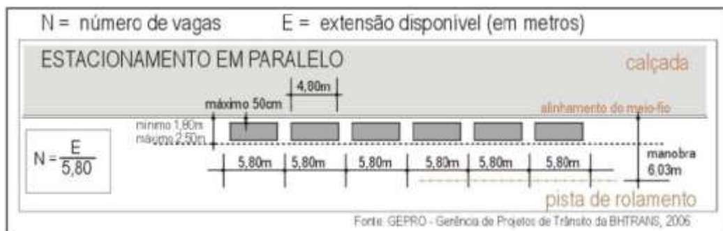
Figura 48 – Dimensionamento do número de vagas no estacionamento em paralelo. Fonte: Adaptado de BHTRANS (2010)
