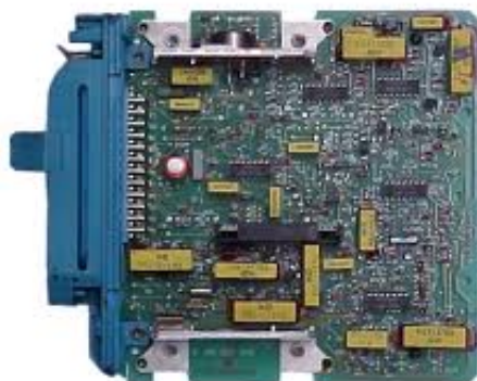
Figura 2.3: Sistema analógico Bosch LE-Jetronic (Kadettclube, 2011).
