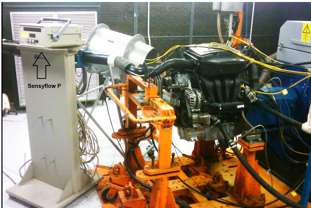
Figura 3.6: Bancada de teste com o medidor Sensyflow acoplado.
