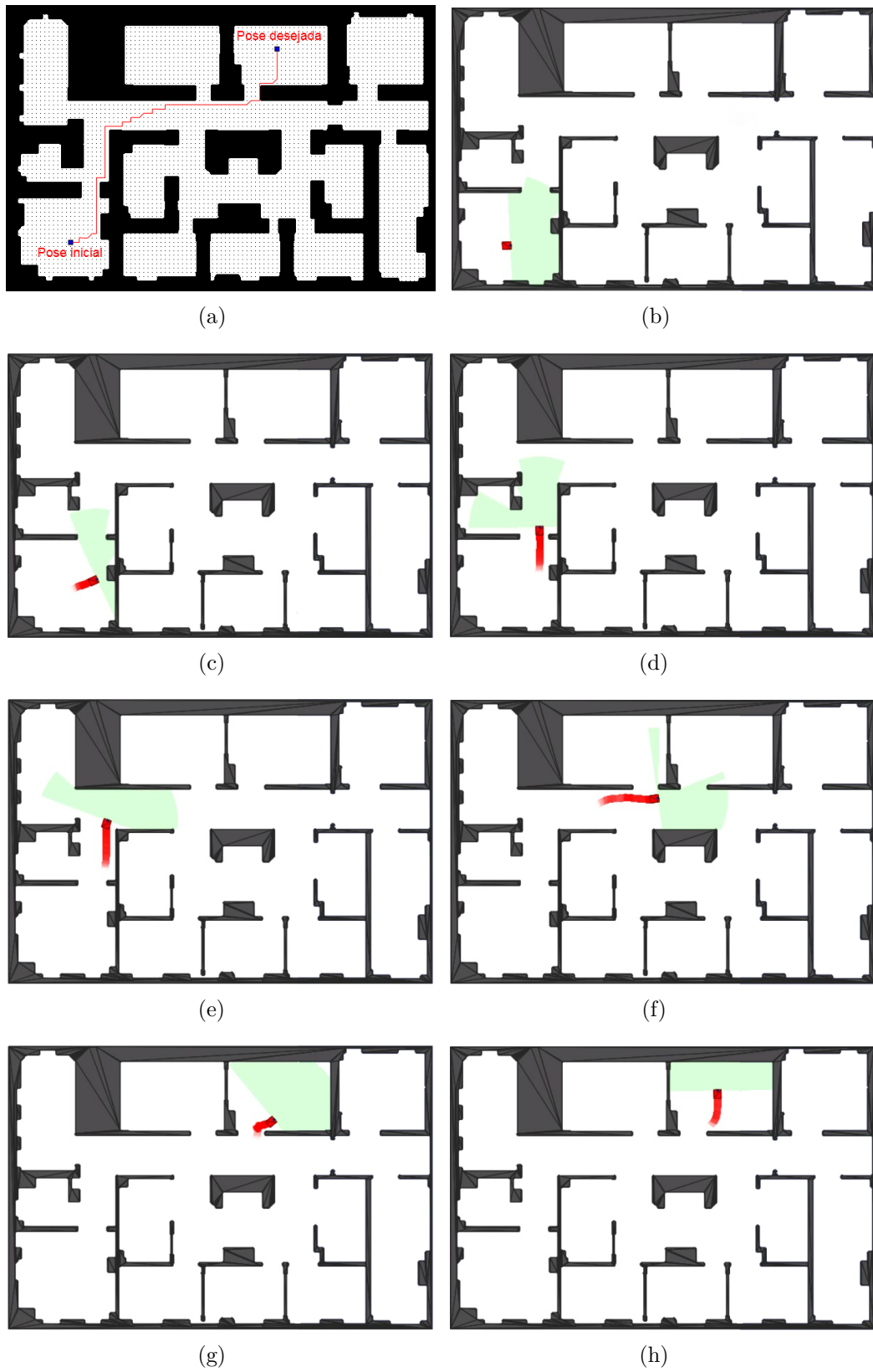
Figura 4.17: Execução do planejador de caminhos em simulação, utilizando um mapa desenhado similar a um ambiente doméstico. A tarefa foi ir de uma pose inicial até uma pose desejada, (a) trajetória completa mostrada no mapa dilatado; (b) robô saindo da pose inicial; (c), (d), (e), (f) e (g) robô executando a trajetória; (h) robô chegando a pose desejada.
