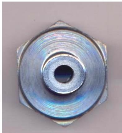
Figura 3.2 – Configuração do dispositivo de interconexão entre a pré-câmara e câmara principal com único furo central de 6,00 mm de diâmetro. MOREIRA (2009).
