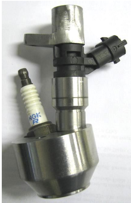
Figura 2.44 – Corpo de Alojamento Final da Pré-Câmara. MOREIRA (2009).
