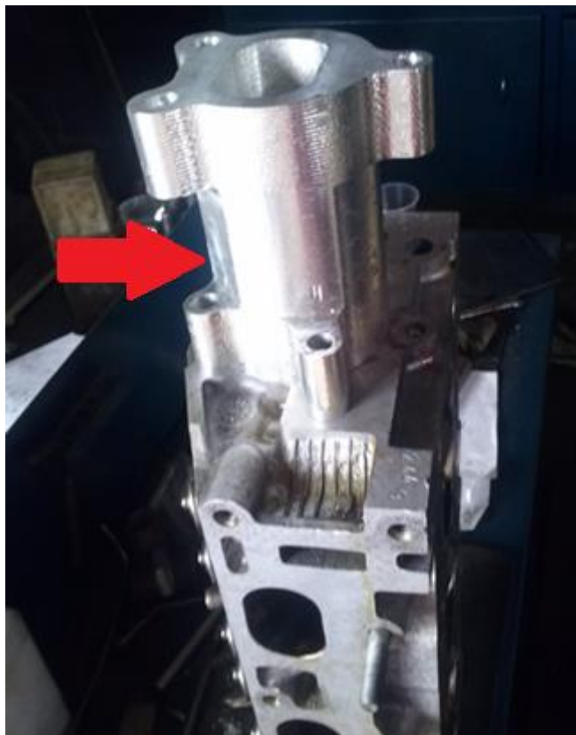
Figura 3.16 – Peça para adaptação do sensor de pressão na câmara de combustão principal.
