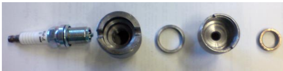
Figura 2.42 – Partes constituintes da pré-câmara de ignição homogênea desenvolvida por BAPTISTA. BAPTISTA (2007).
