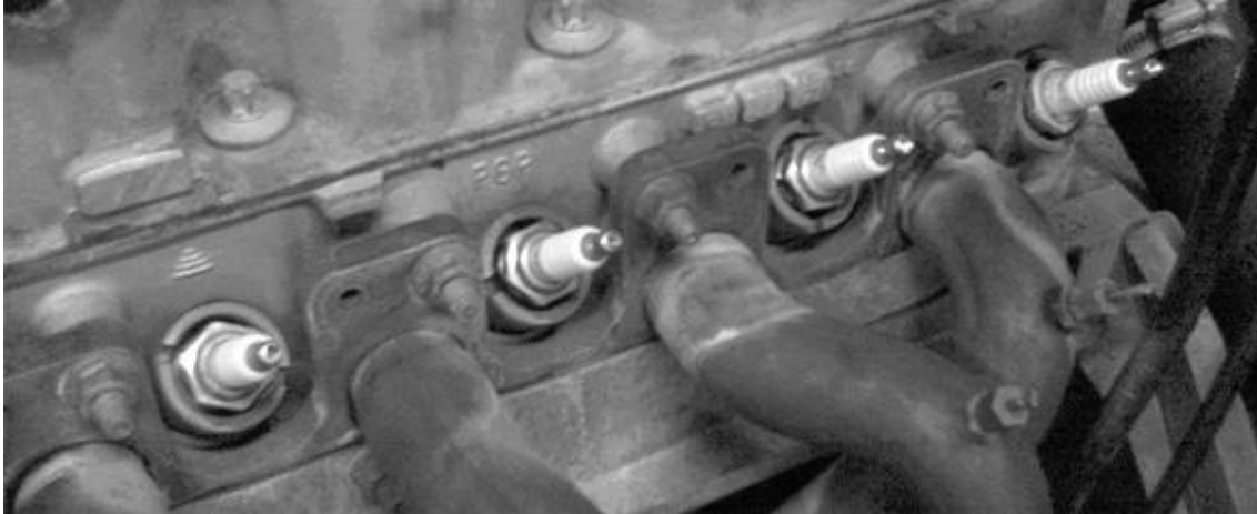
Figura 2.43 – Pré-câmaras montadas do sistema de ignição por lança chamas homogênea desenvolvida por BAPTISTA. BAPTISTA (2007).
