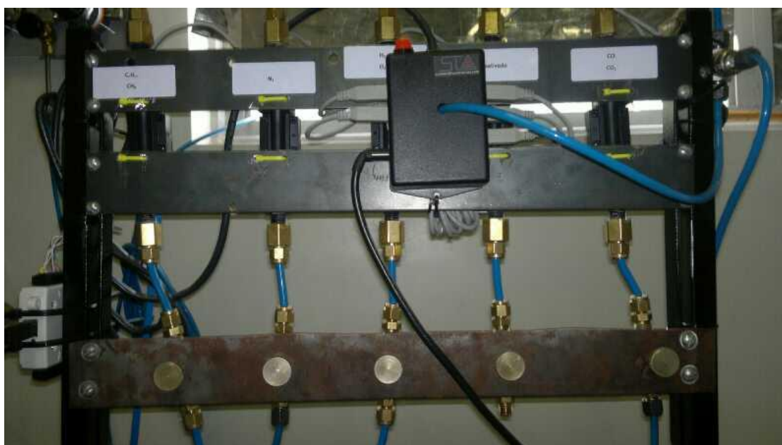
Figura 3.13 – Medidores de vazão e sistema de aquisição de dados da bancada de calibração de gases.
