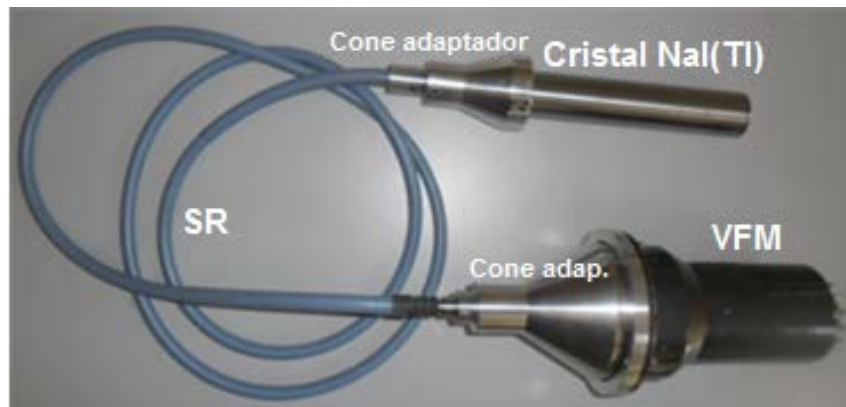
Fig. 4.23. Cristal de NaI(TI), ligado à VFM através da SR, constituindo o detector DL2.
