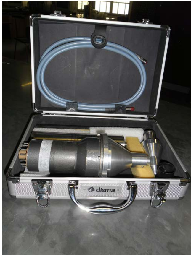
Fig. 4.11. Pequena e segura maleta com os cristais detectores, VFM e FO acondicionados para facilidade de transporte, cujo peso total é de 2,5 kg.
