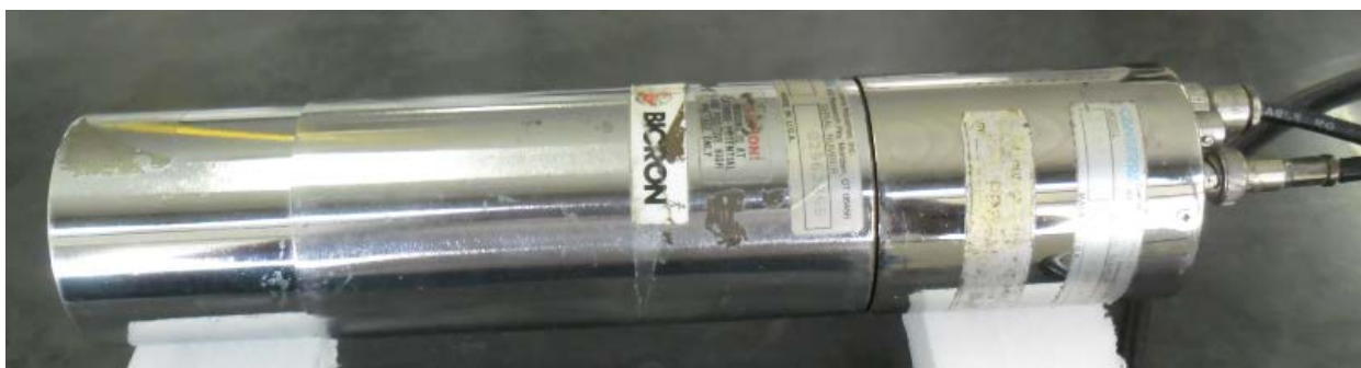
Fig. 4.19. DL1 – Detector NaI(Tl) modelo 802-3 utilizado no sistema convencional (cristal acoplado à válvula fotomultiplicadora).
