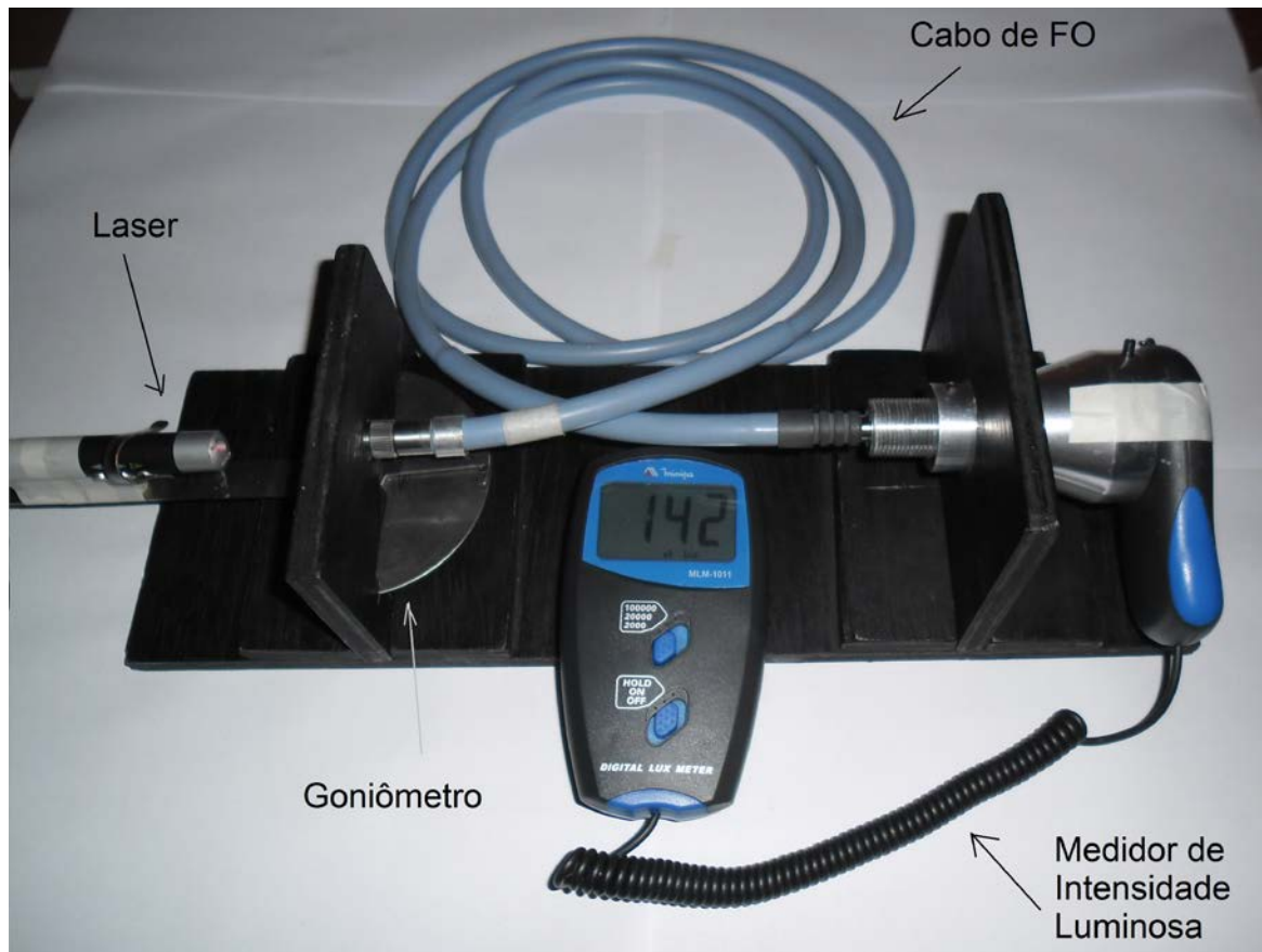
Fig. 4.12. Dispositivo para medida do ângulo de aceitação da FO, através de uma luz laser e um medidor digital de iluminância, (MLM-1011) Minipa, alcance de 1 a 100.000 lux.
