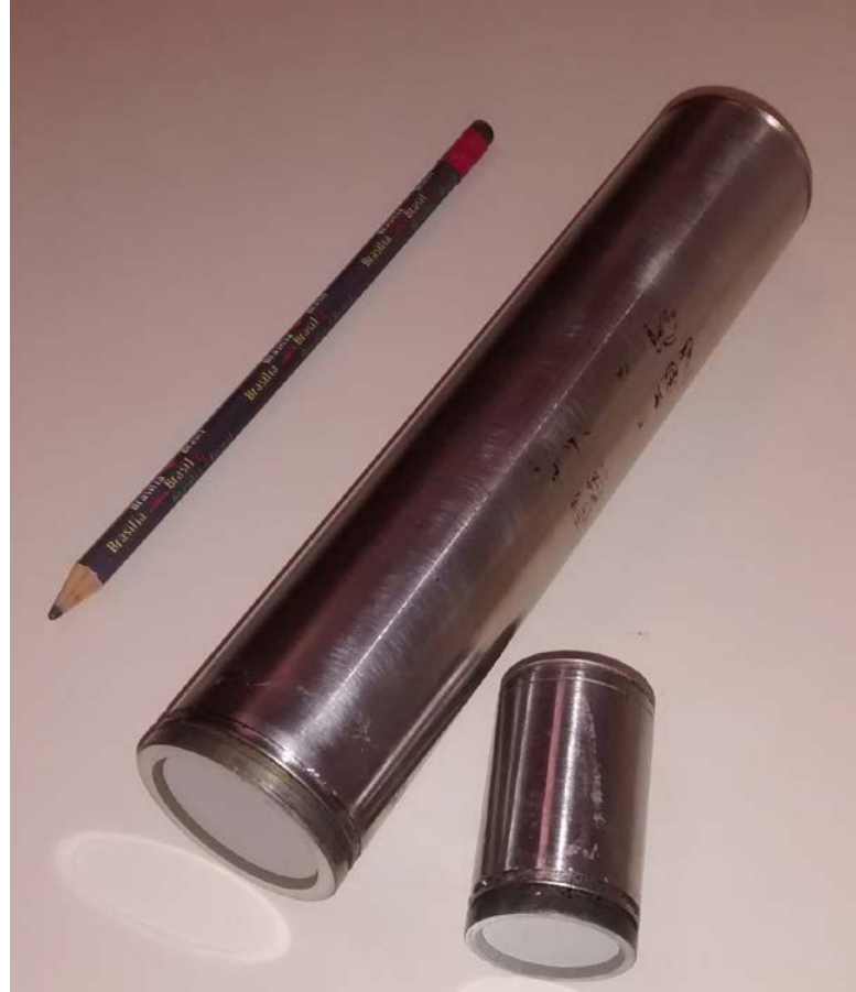
Fig. 4.10. Dois cristais de NaI(Tl) do LIN com diferentes volumes sensíveis.
