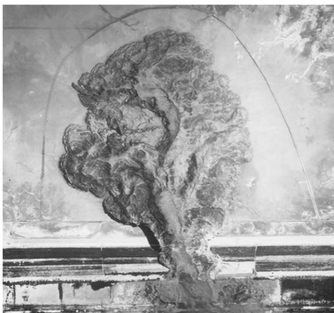
FIGURA 3.17 – Vista aérea da cicatriz no reservatório da barragem de Merriespruit Fonte: BLIGHT, 2010
