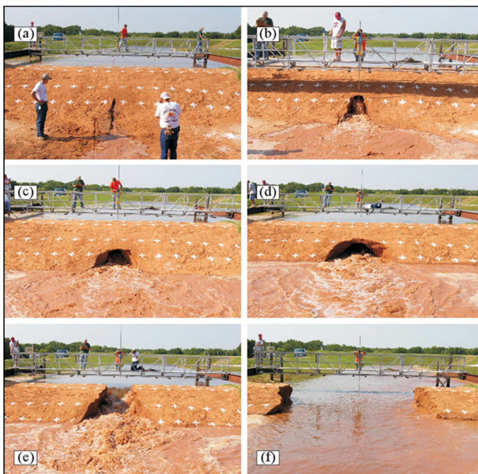
FIGURA 3.21 – Ensaio de ruptura de campo para análise da formação da brecha por piping
