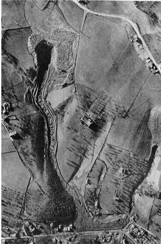
FIGURA 3.6 – Vista aérea do fluxo de rejeitos após o acidente em Jupille Fonte: BISHOP, 1973
