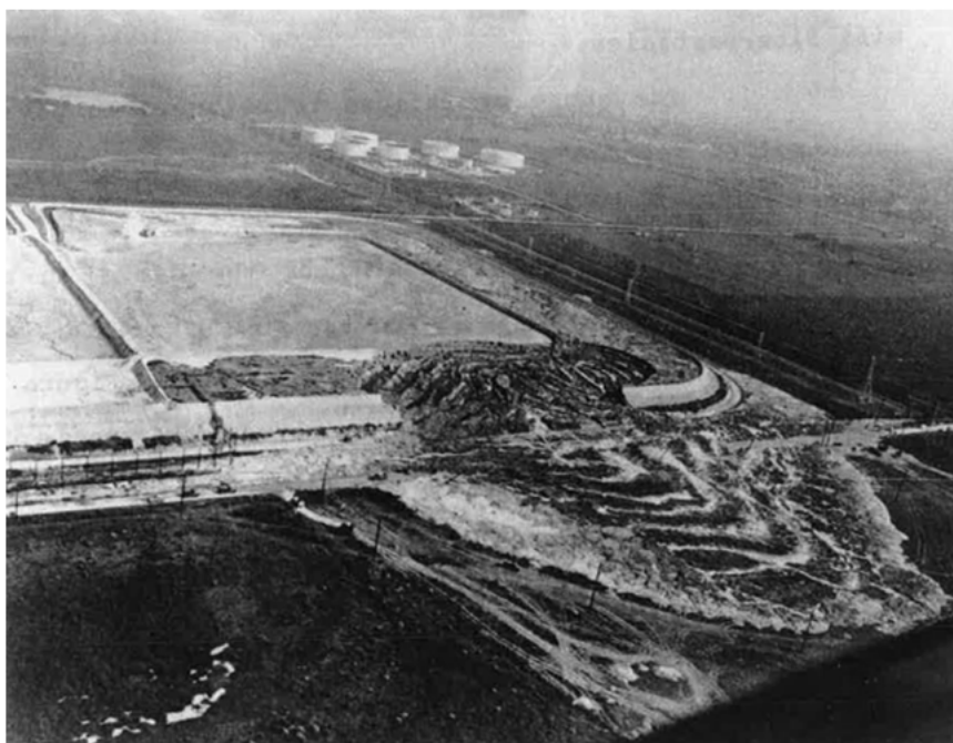
FIGURA 3.5 – Vista aérea da extensão da inundação após a ruptura da barragem de rejeitos de gesso, Texas – EUA
