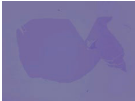
FIGURA 2.14 – Cristal de grafeno largo preparado através da técnica de fita adesiva FONTE – GEIM, 2009, p. 1530
