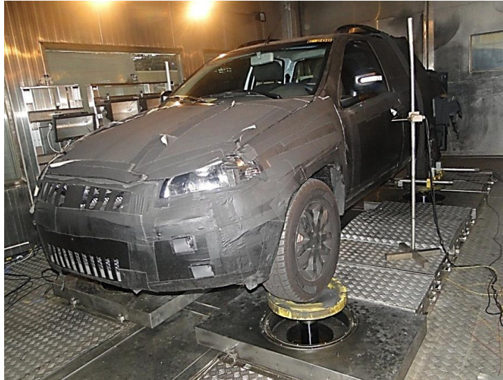
FIGURA 3.11 – Four-poster utilizado para reprodução dos sinais
