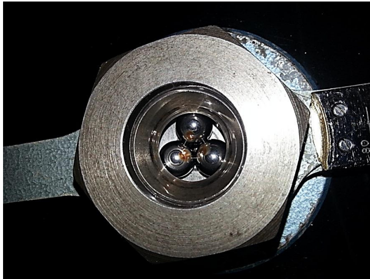
FIGURA 3.1 – Esferas estacionárias no suporte do Four-ball
