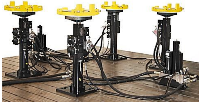
FIGURA 2.34 – Disposição dos atuadores hidráulicos do simulador de estradas
