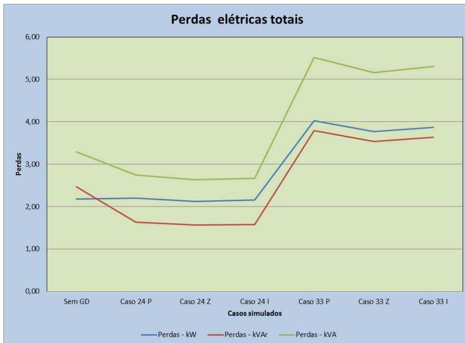
Figura 4.32 – Perdas totais em função da modelagem de carga
