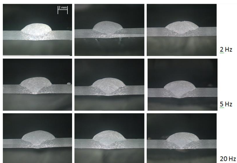
Figura 2.14: Cordões de solda [25]. Frequências utilizadas de 2Hz, 5Hz e 20Hz.
