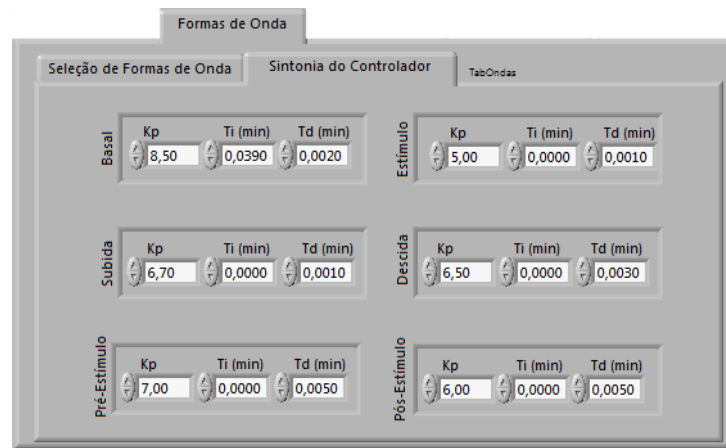
Figura 24: Aba para a sintonia do controlador PID do VI Estimulador térmico versátil.
