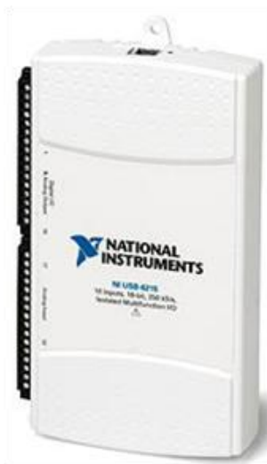
Figura 117: Características principais do sistema de aquisição de dados NI USB-6211. Fonte: (NATIONAL INSTRUMENTS, 2006).
