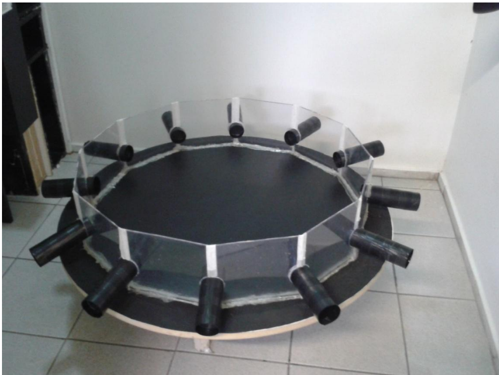
Figura 7- Foto do Labirinto em Tanque Raso utilizado no presente estudo. Consiste em um equipamento circular com doze saídas, sendo apenas uma verdadeira. Detalhes no item 4.3.
