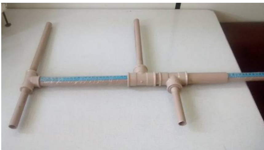
Figura 4. Hipômetro de PVC confeccionado a partir de tubos e conexões
