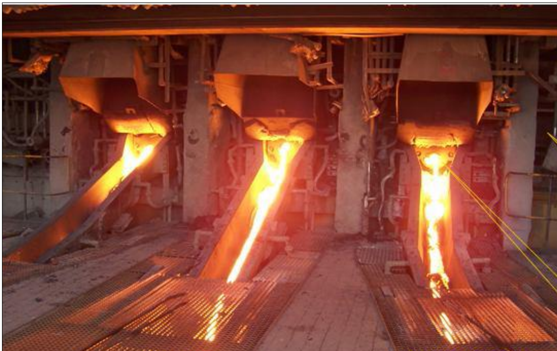
Figura 15 – Vazamento de escória em outra planta industrial
