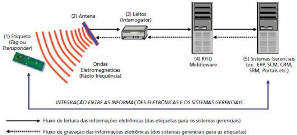
Figura 1: Funcionamento de sistemas RFID
