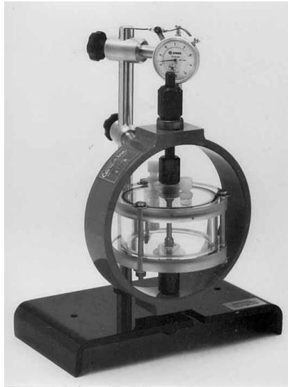
Figura 5: Montagem da célula de teste através do método de anéis. (Fonte: NACE TM0177-2005).
