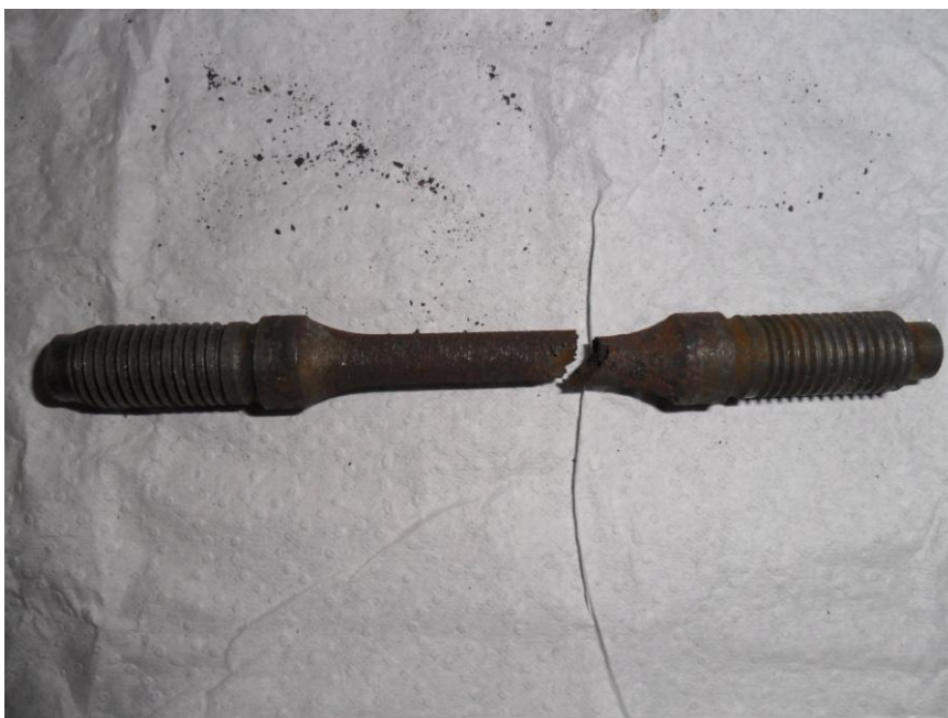
Figura 2: Peça fraturada por corrosão sob tensão. (Fonte: V & M do BRASIL).
