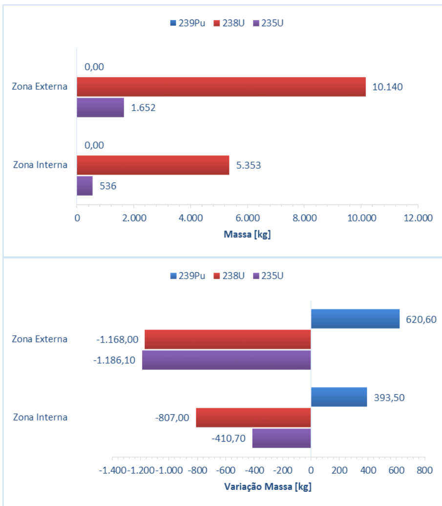
Figura 4-17. Composição inicial em massa dos principais actínídeos no início do ciclo, e variação no final do ciclo de operação.
