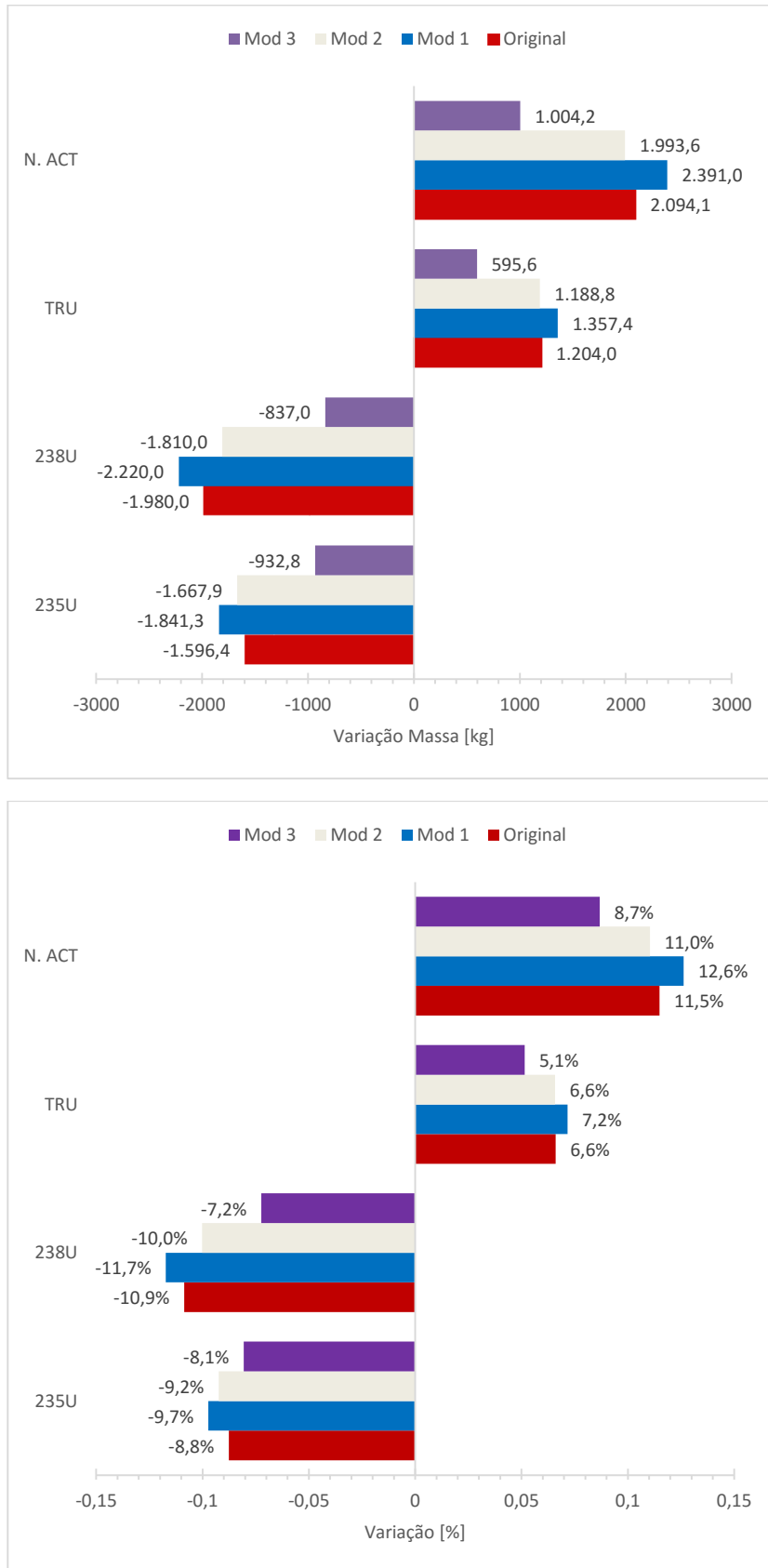
Figura 5-10. Variação e percentual em massa do combustível metálico para os modelos analisados, EOL.
