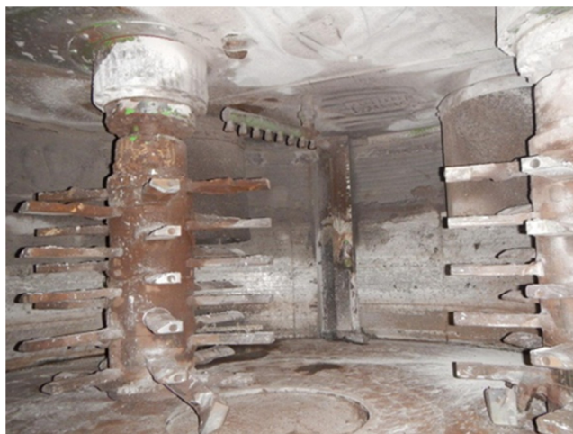
Figura 3.41– Fotografia do interior do misturador intensivo da Sinterização número 2 da Arcelor Mittal Gent. Fonte: LUDIVINE et al (2014).
