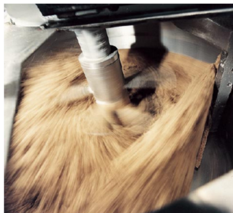
Figura 3.24 - Intensidade do movimento das matérias primas no interior do misturador intensivo. Fonte: (REIDESCHLAEGER et al, 2013).
