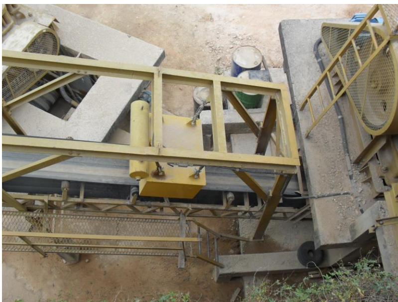
FOTO 10: Extrator eletromagnético da usina de reciclagem da BR 040.
