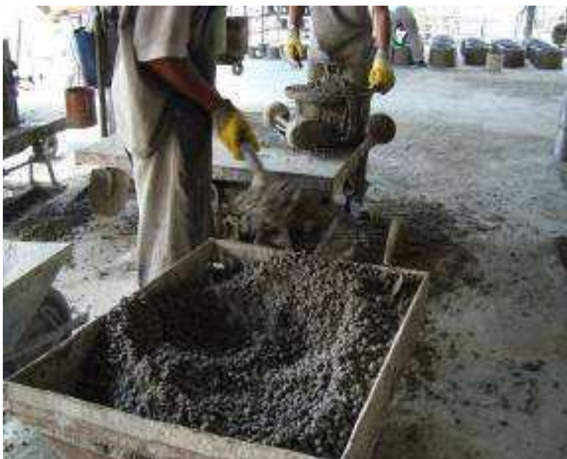
FOTO 12: Concreto seco para fabricação das peças para ensaio.
