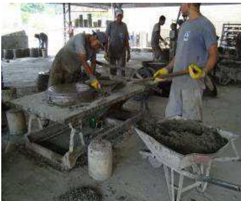
FOTO 13: Moldagem dos corpos de prova.
