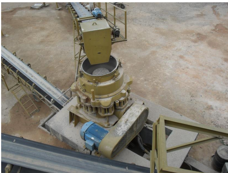
FOTO 7: Britador secundário da usina de reciclagem da BR 040.
