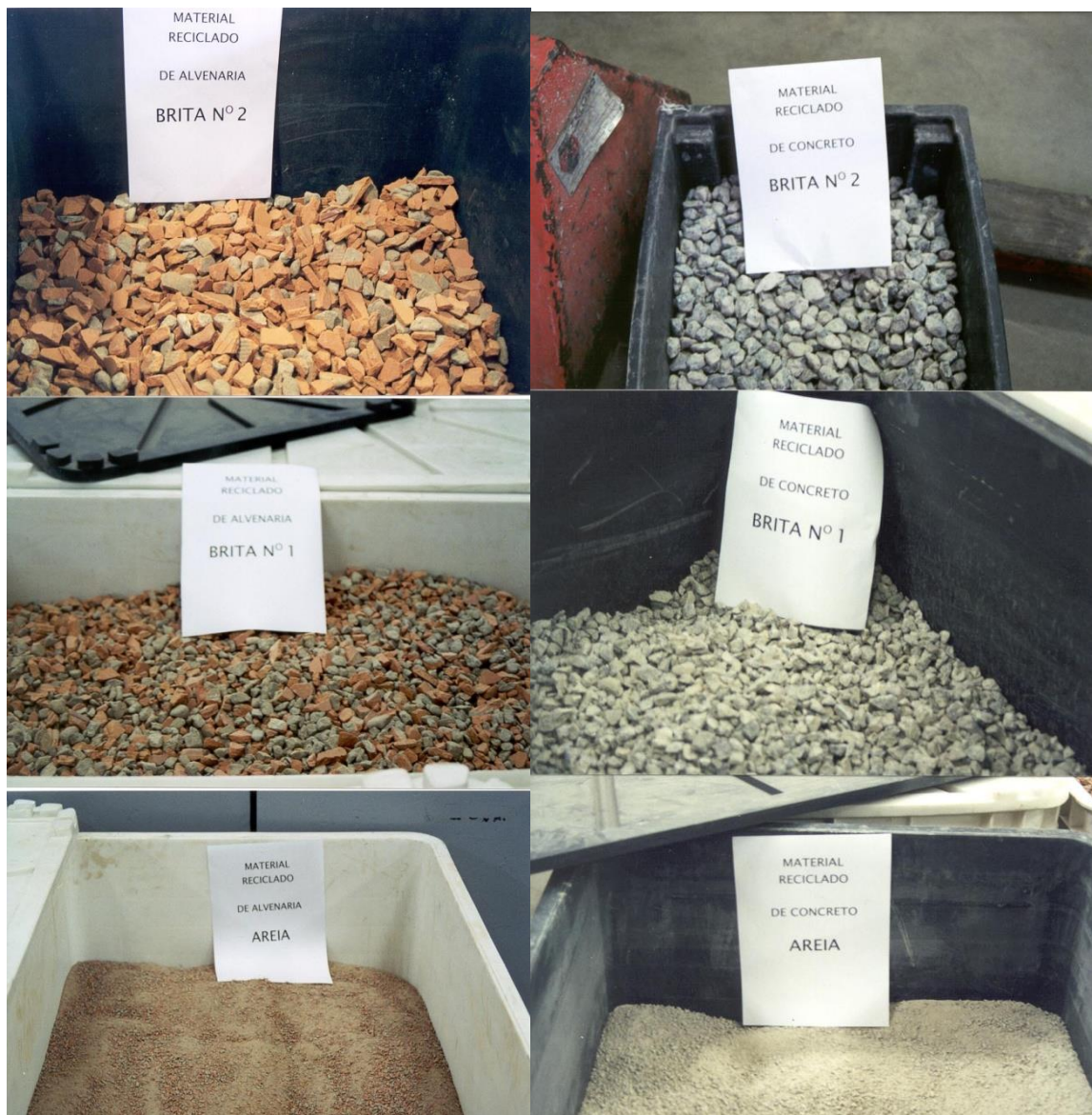
FOTO 4: Agregados reciclados produzidos individualmente, situação ideal.
