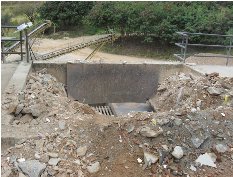
FOTO 5: Alimentador vibratório da usina de reciclagem da BR 040.
