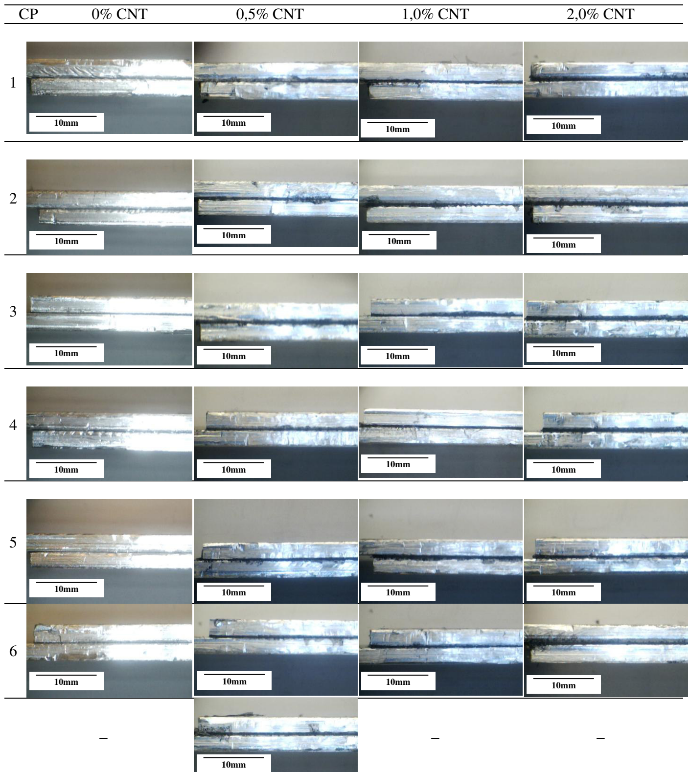
Figura 68: Imagens laterais da região de sobreposição das juntas coladas.
