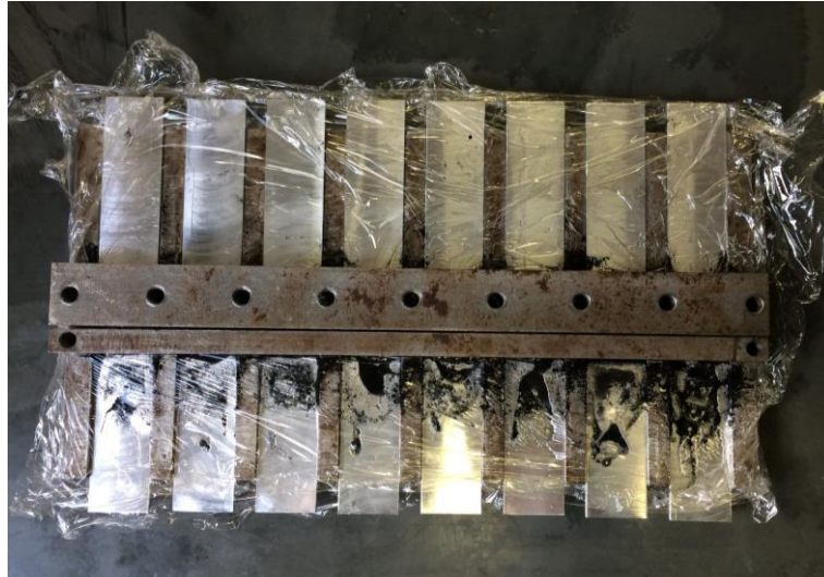
Figura 32: Posicionamento dos CPs com a utilização dos dispositivos de colagem do Laboratório de Compósitos da UFMG.
