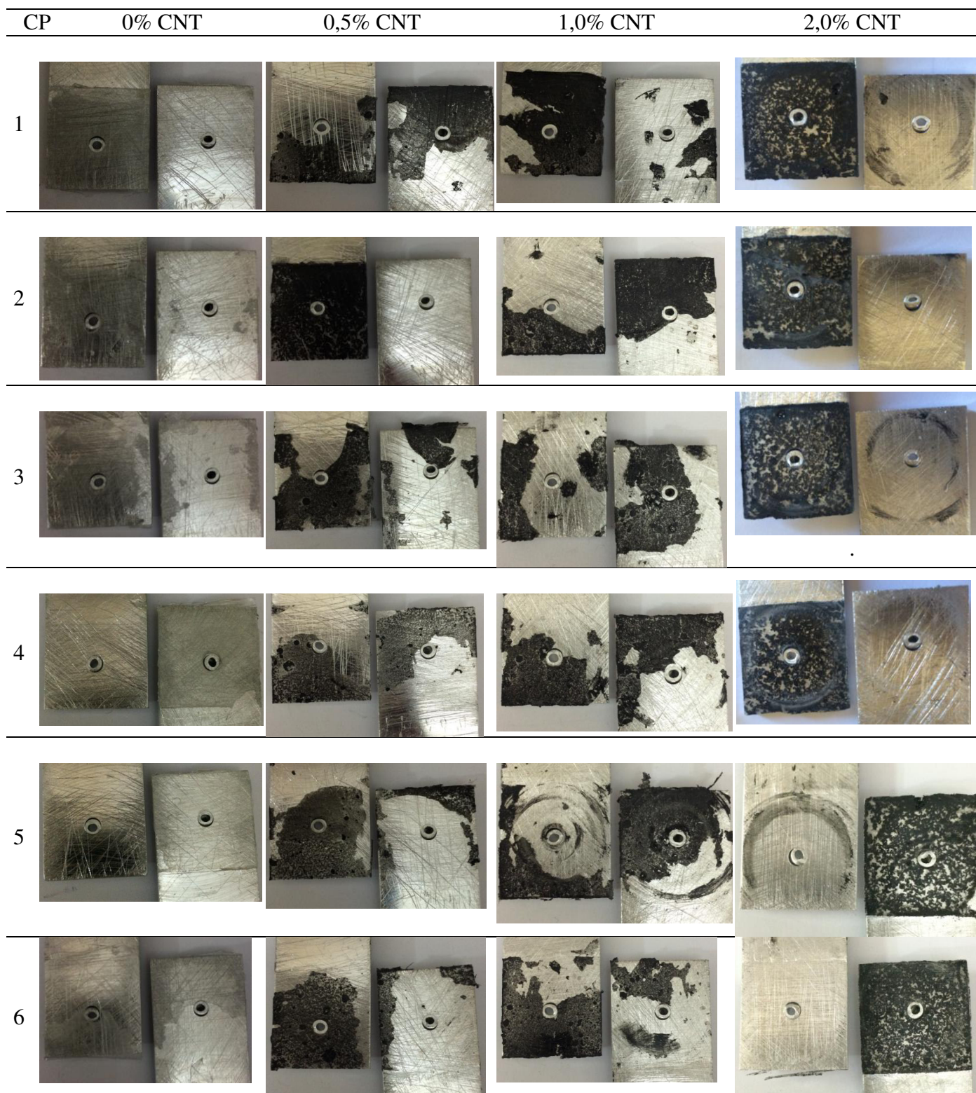
Figura 72: Modos de falha – juntas híbridas.
