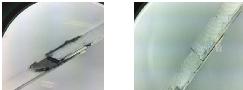
Figura 33: CP antes e depois da remoção do tapering .
