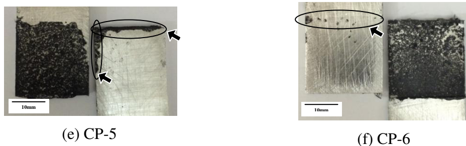
Figura 45: Modos de falha das juntas coladas com 2,0% CNT.
