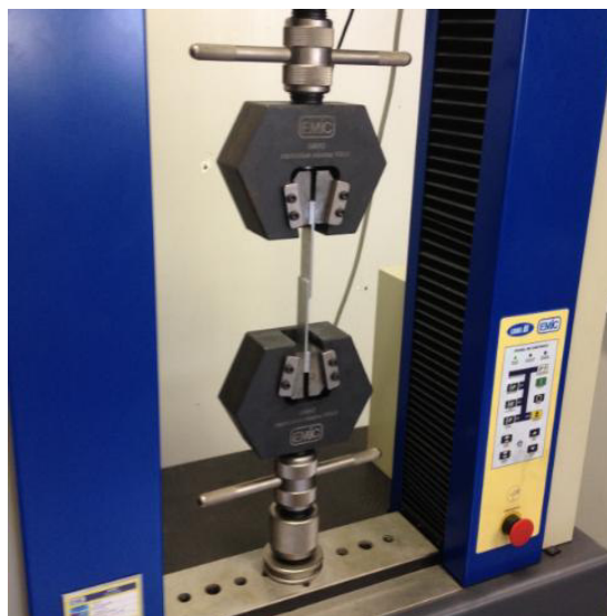
Figura 35: Corpo de prova posicionado para ensaio na Máquina de ensaios universal.
