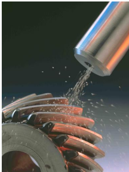
Figura 3.4 - Esquema de jateamento por shot peening em uma engrenagem.
