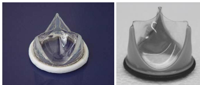
FIGURA 2.3 –Válvulas poliméricas (DAEBRITZ et al. , 2004; YAP et al. , 2012)
