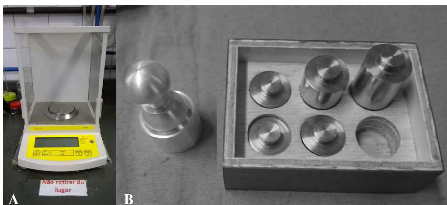
FIGURA 3.18 – Calibração da balança de precisão. A) Balança utilizada. B) Corpos de massas padrão
