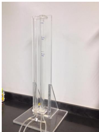
FIGURA 3.17 – Coluna d'água utilizada para calibração
