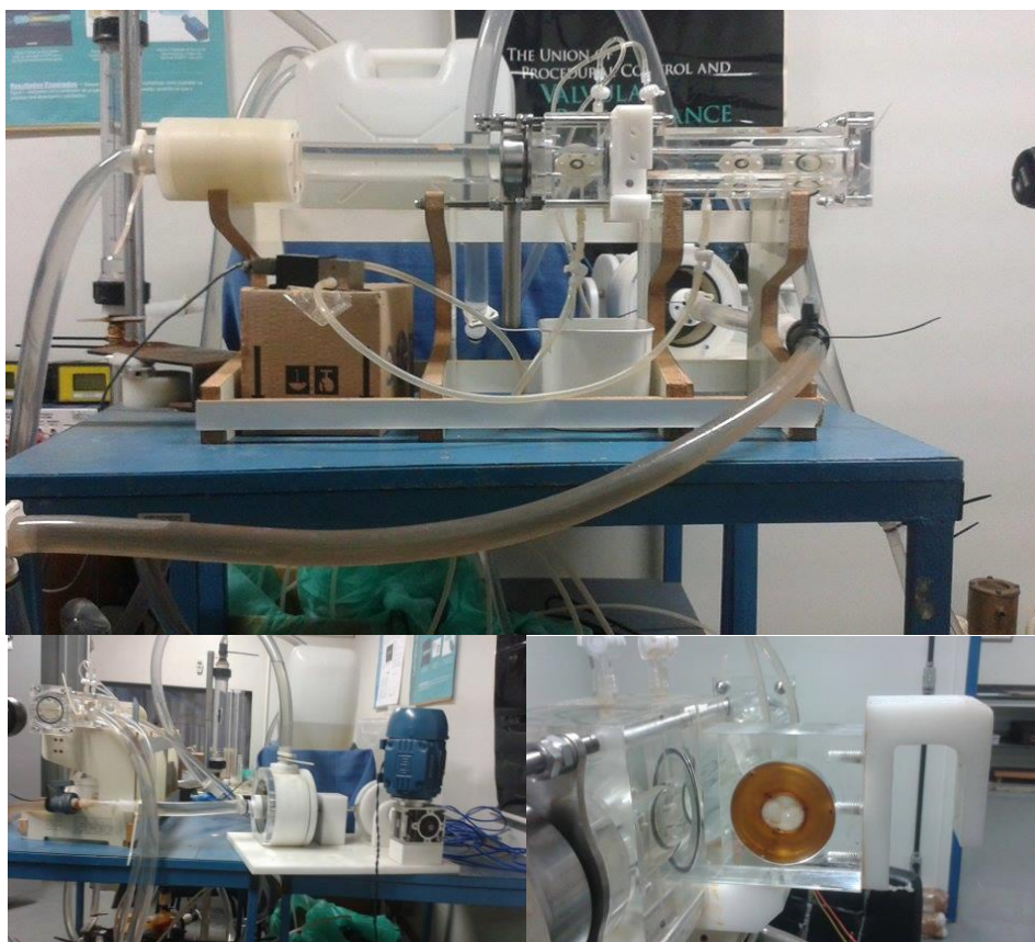
FIGURA 3.9 – Bancada de teste de válvulas cardíacas
