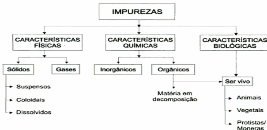
Figura 1: Impurezas contidas na água. Fonte: VON SPERLING, 2005.
