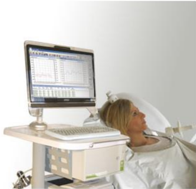
Figura 3. Quark RMR (Cosmed, Rome, Italy), sistema campânula. Fonte: COSMED
