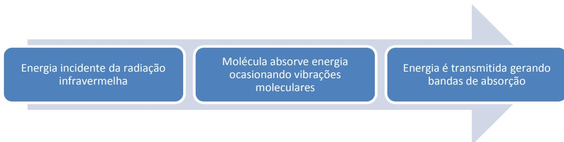
**FIGURA 1: Representação simplificada da espectroscopia no infravermelho.**
