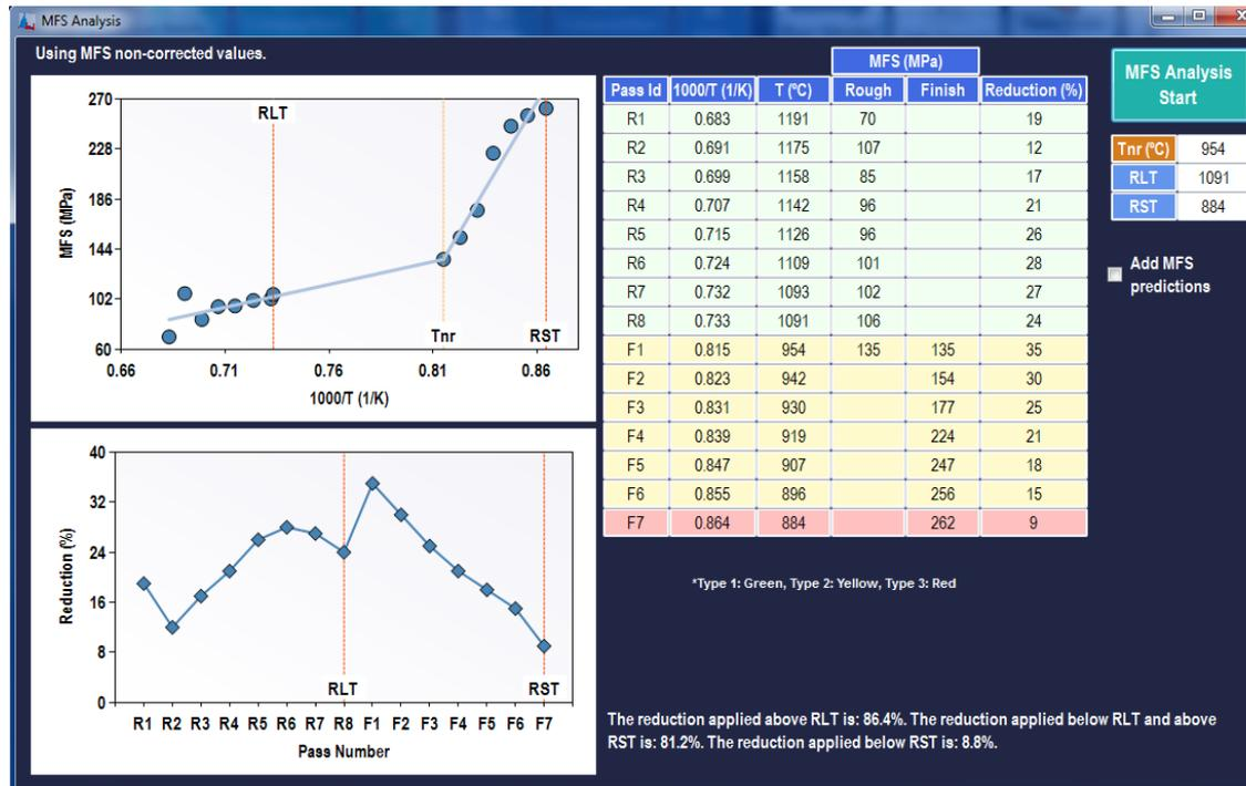
Figura 6-8 - Tela de saída apresentando gráficos para análise da tensão de fluxo média, TFM, ou em Inglês, MFS, e de estratégia de redução utilizada na sequência de passes.
